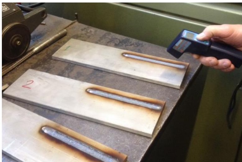
Slika 30. Mjerenje međuprolazne temperature
