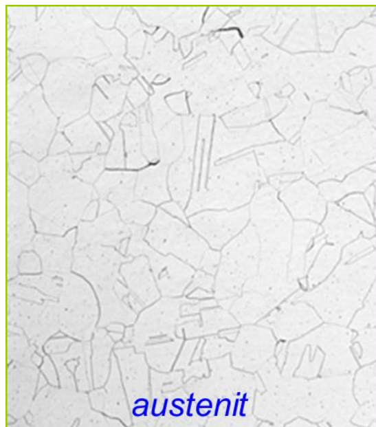
Slika 2. Mikrostruktura austenitnog čelika [7]
