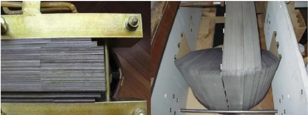
Slika 8. Slaganje limova u jezgru. [12]
