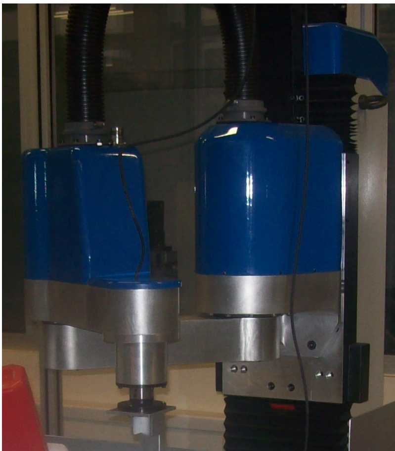
Slika 26. Robotska ruka SCARA sa adekvatnim prihvatom za nosač obradka
