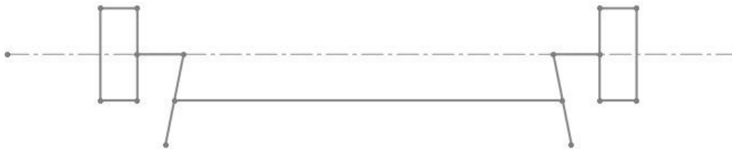
Slika 29. Davisov sustav s letvom iza osovine
