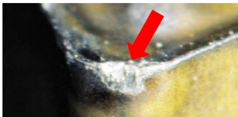
Slika 24. Krzanje oštrice alata [1]
