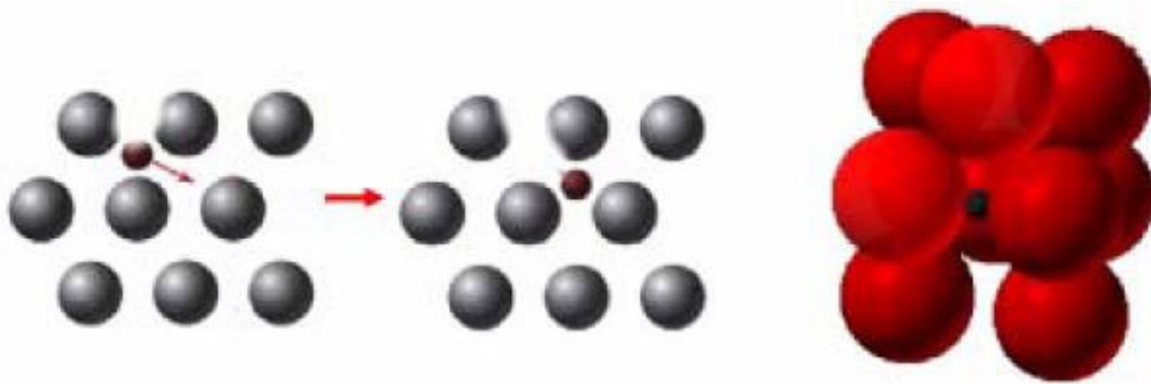
Slika 17. Intersticijski mehanizam kretanja atoma [11]
