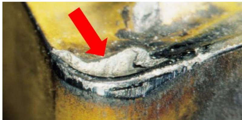
Slika 21. Kratersko trošenje alata [5]
