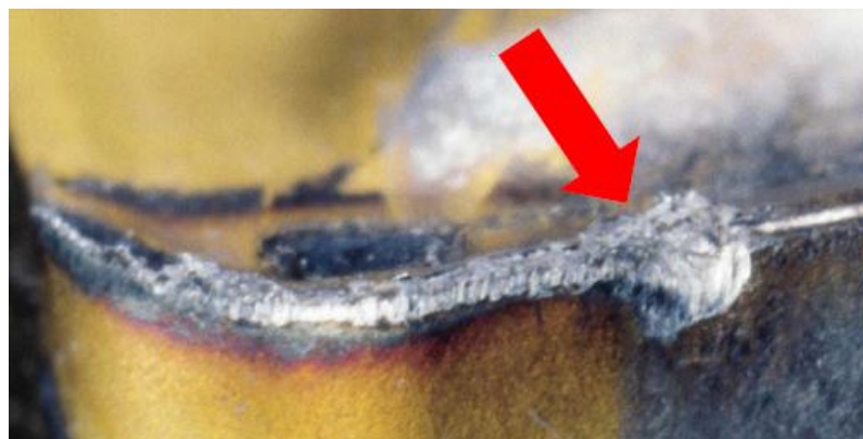
Slika 22. Zarežno trošenje alata [5]
