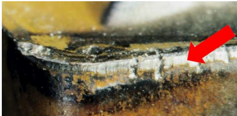
Slika 23. Toplinska napuknuća na alatu [1]
