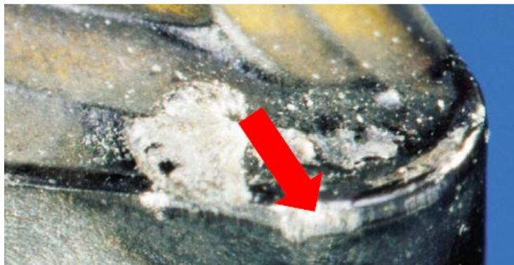
Slika 25, Naljepak na oštrici alata [5]
