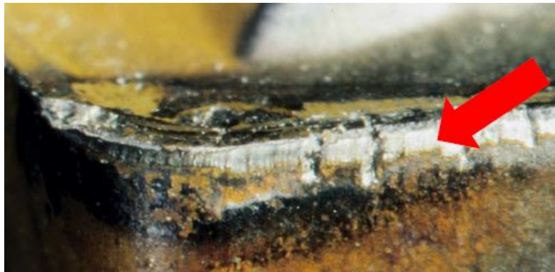
Slika 23. Toplinska napuknuća na alatu [1]
