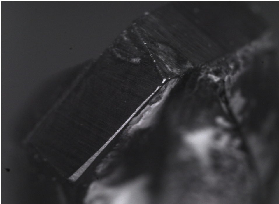
Slika 64. Izgled rezne oštrice i stražnje površine "1" svrdla "A2" nakon 1378 izbušenih provrta
