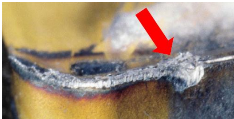
Slika 22. Zarežno trošenje alata [5]
