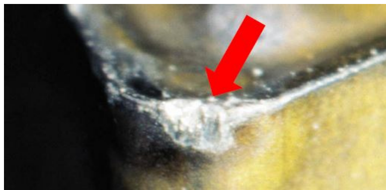
Slika 24. Krzanje oštrice alata [1]
