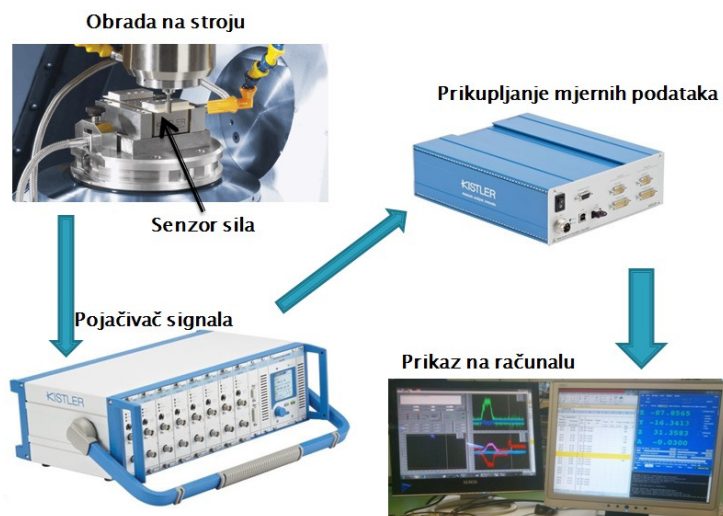
Slika 45. Primjer toka i obrade signala iz senzora sila [40]
