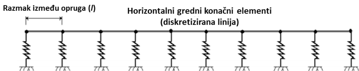
Slika 14. Diskretizirani pristup proračuna grede na elastičnoj podlozi [38]
