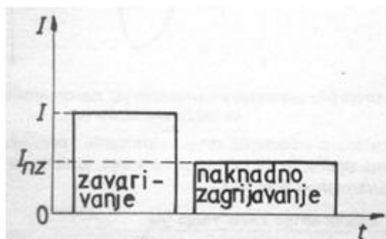
Slika 14. Zavarivanje s naknadnim zagrijavanjem [1]
