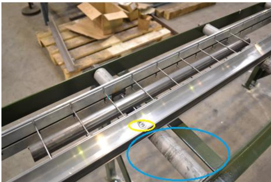
Slika 41. Dio šablone za postavljanje žica i cijevi [19]
