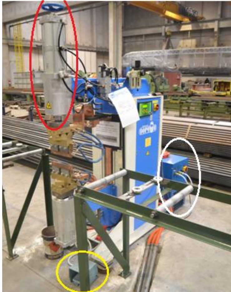
Slika 40. Stroj za bradavičasto elektrootporno zavarivanje sklopa žica-cijev [19]
