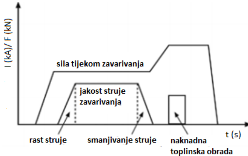
Slika 8. Tipičan dijagram jakosti struje, vremena te sile pritiska kod elektrootpornog zavarivanja [4]
