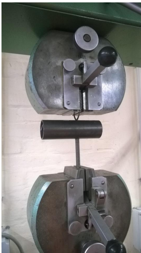
Slika 51. Ispitivanje probom čupanja [19]
