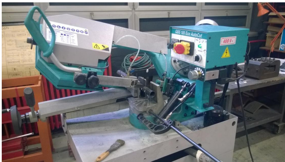
Slika 43. Priprema uzoraka rezanjem na tračnoj pili [19]
