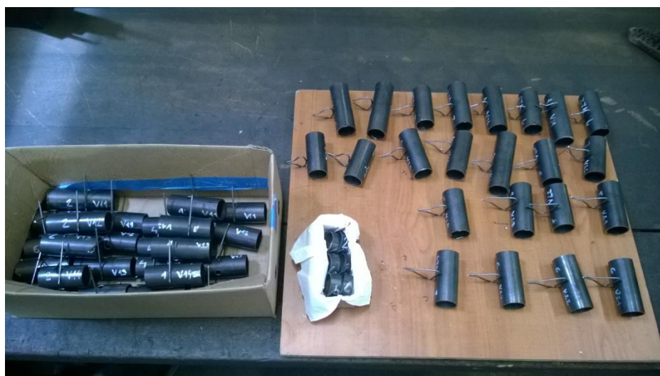
Slika 44. Svi uzorci pripremljeni za ispitivanja prema HRN EN ISO 15614-12:2007 [19]
