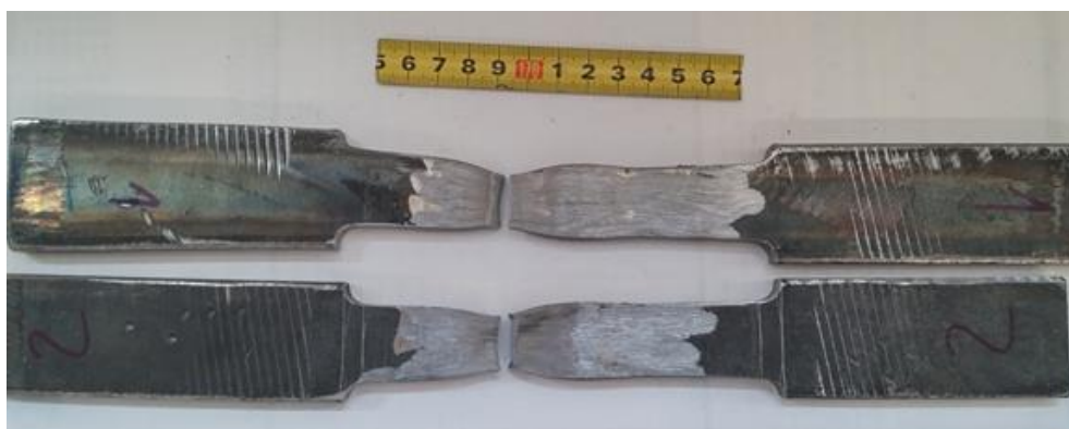
Slika 47. Izgled epruveta nakon statičkog vlačnog pokusa
