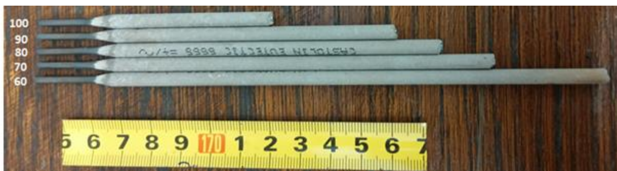
Slika 22. Ostatci Castoline-ovih elektroda nakon zavarivanja - DC(+)
