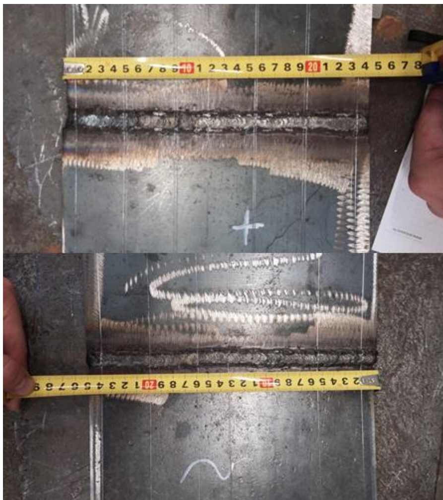
Slika 34. Označavanje i priprema ploča za plinsko rezanje
