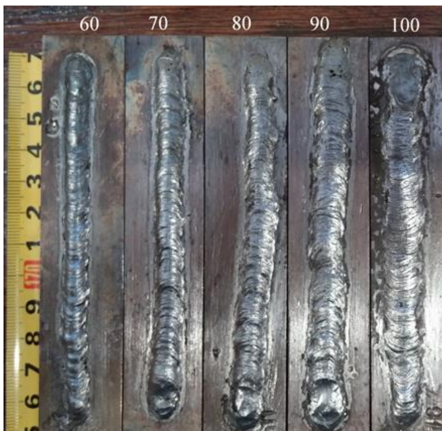
Slika 21. Epruvete nakon čišćenja - Castoline DC(+)
