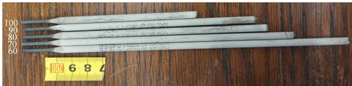
Slika 28. Ostatci BÖHLER FOX EV 50 elektrode nakon zavarivanja
