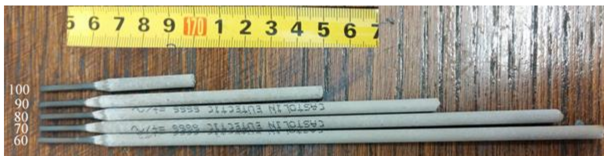
Slika 25. Ostatci Castoline-ovih elektroda nakon zavarivanja izmjeničnom strujom
