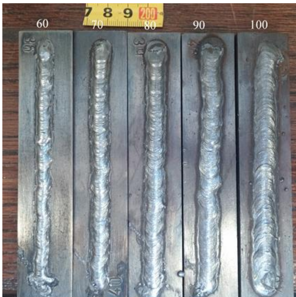
Slika 27. Epruvete nakon čišćenja - BÖHLER FOX EV 50
