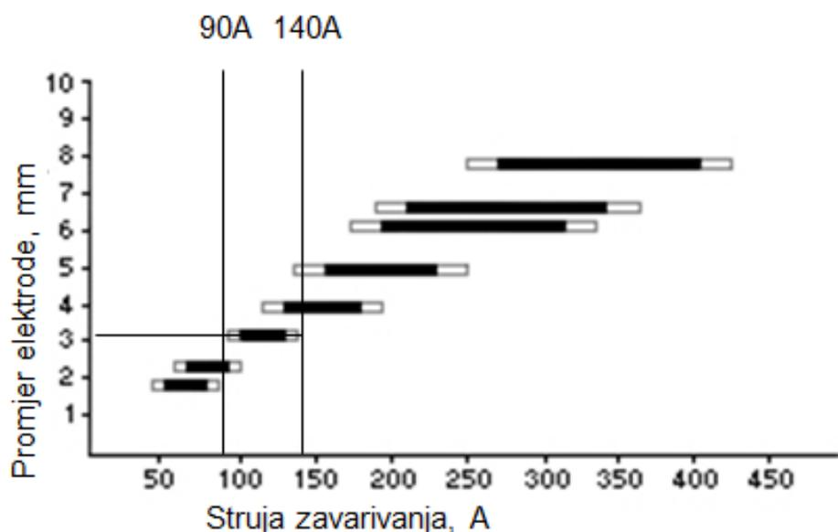
Slika 2. Struja zavarivanja u ovisnosti o promjeru elektrode [7]
