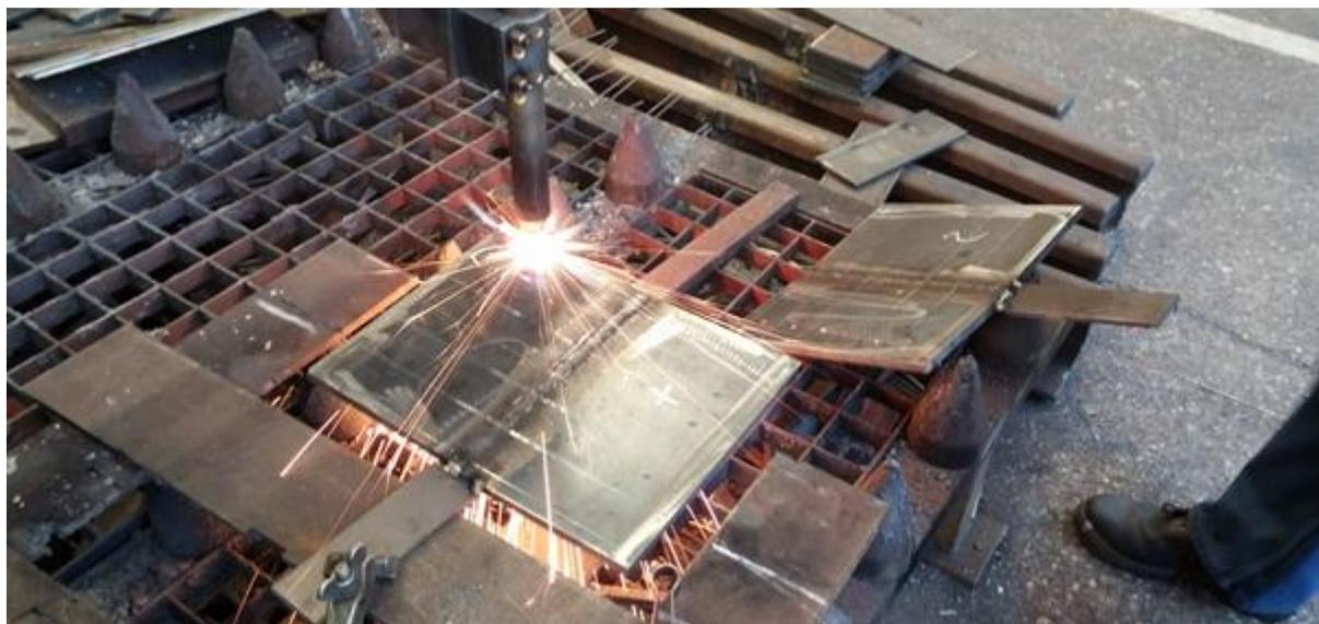
Slika 35. Plinsko izrezivanje epruveta
