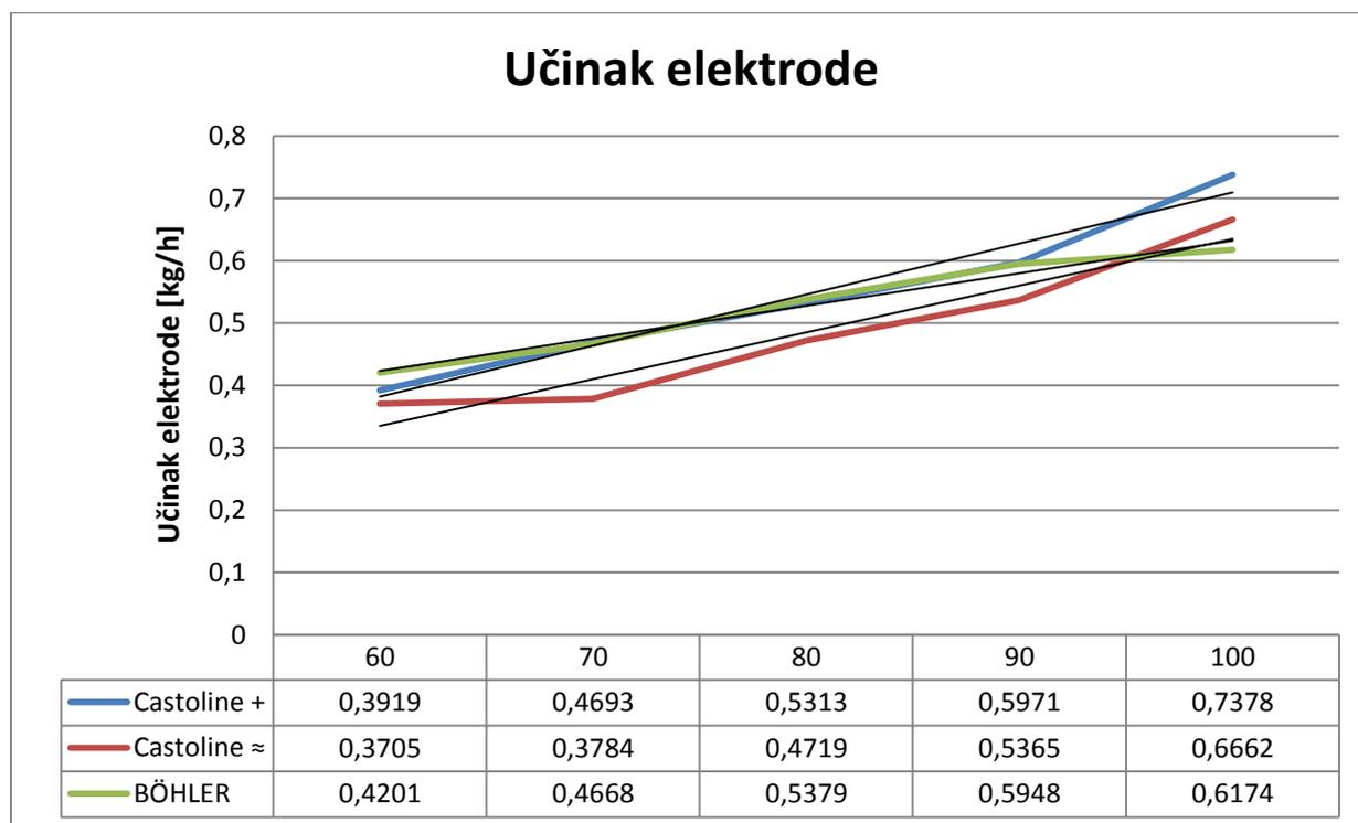
Linearnom aproksimacijom dobivenih rezultata učinka elektrode moguće je doći do jednadžbi za izračun učinka elektrode. Važno je napomenuti da su ovo jednadžbe dobivene na temelju eksperimentalno dobivenih podataka, te da vrijede samo za elektrode korištene u ovom eksperimentu, te neće biti iste za različite poprečne presjeke elektroda.
