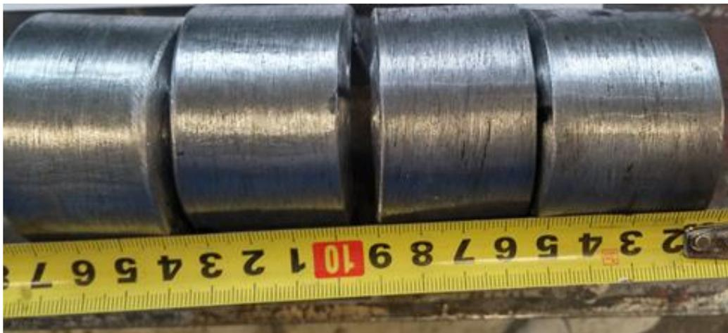
Slika 38. Rezultat ispitivanja savijanjem - DC (+)
