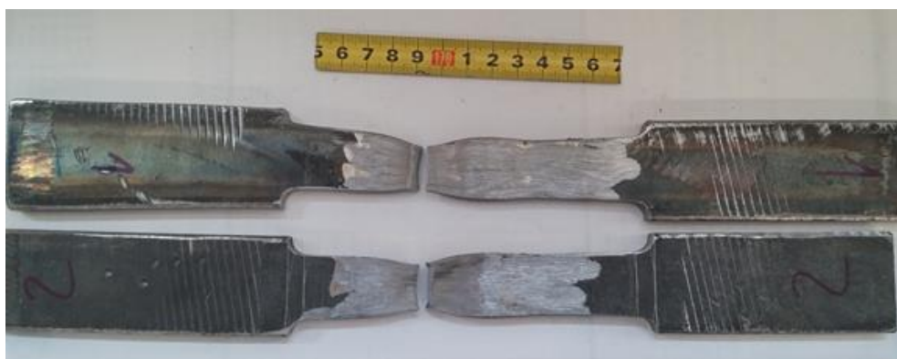
Slika 47. Izgled epruveta nakon statičkog vlačnog pokusa
