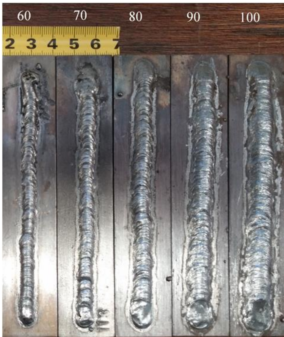
Slika 24. Epruvete nakon čišćenja - Castoline AC
