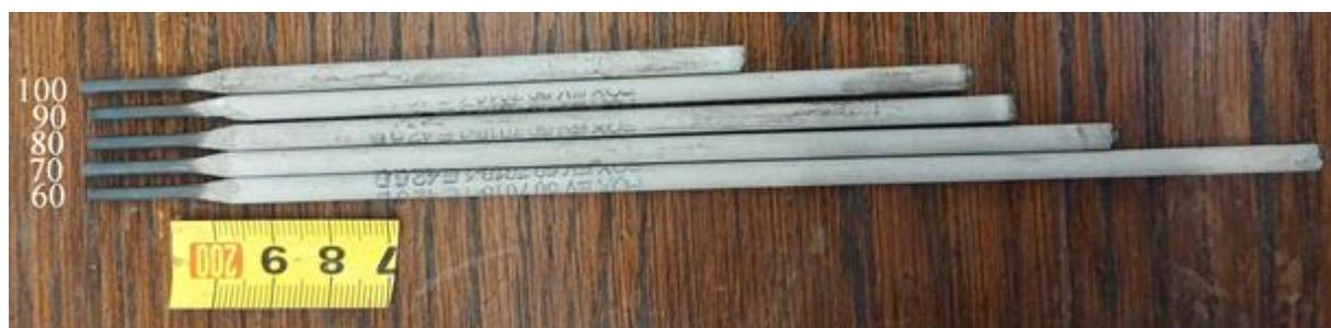
Slika 28. Ostatci BÖHLER FOX EV 50 elektrode nakon zavarivanja
