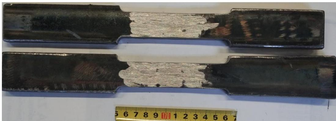
Slika 44. Izgled epruveta za statički vlačni pokus
