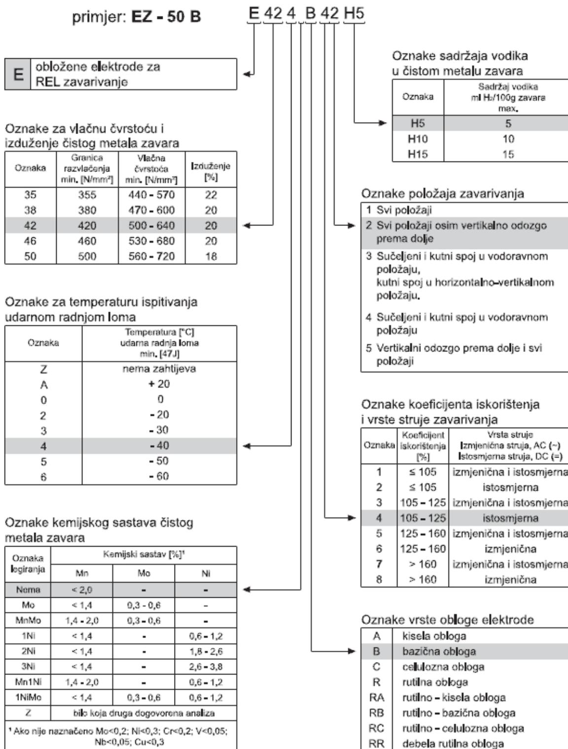
Shema 1. Označavanje elektroda za niskolegirane čelike [10]
