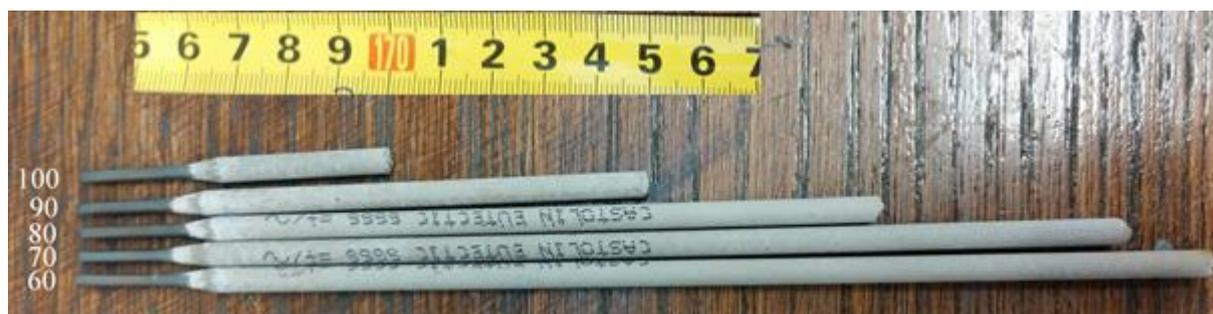
Slika 25. Ostatci Castoline-ovih elektroda nakon zavarivanja izmjeničnom strujom
