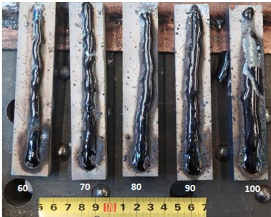
Slika 20. Epruvete nakon zavarivanja - Castoline DC(+)
