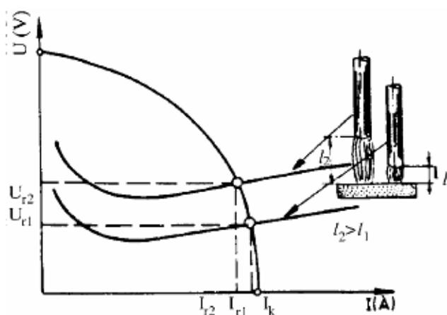
Slika 4. Promjena radne točke kod strmopadajuće karakteristike [4]
