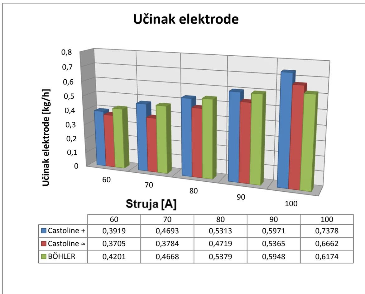
Učinak elektrode je omjer mase istaljenog metala elektrode i vremena zavarivanja.
