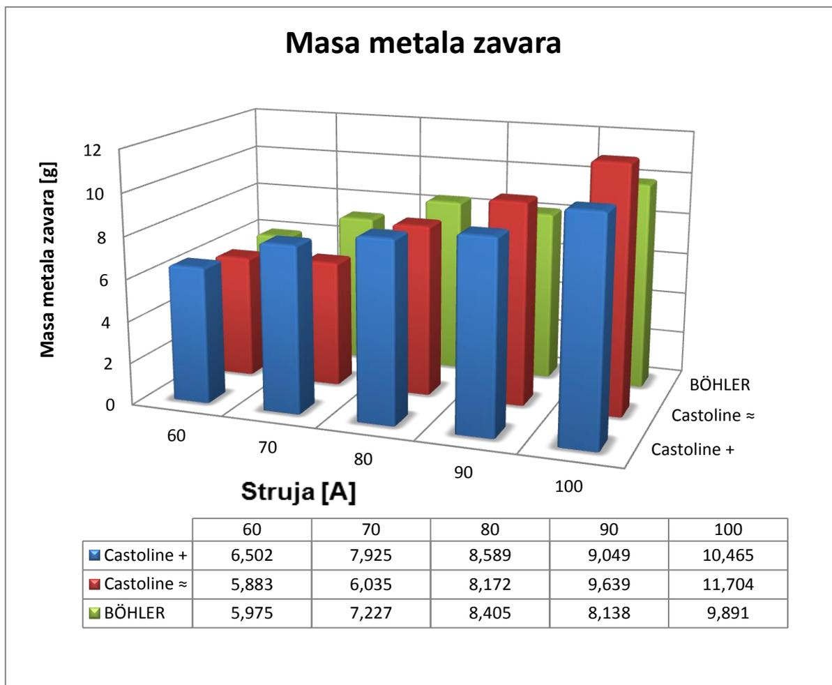
Iz dijagrama dobivenog analizom mase metala zavara može se uočiti povećanje u masi nataljenog metala zavara s povećanjem struje zavarivanja. Castoline-ovom elektrodom je dobiveno više nataljenog metala zavara u odnosu na Böhler-ovu.
