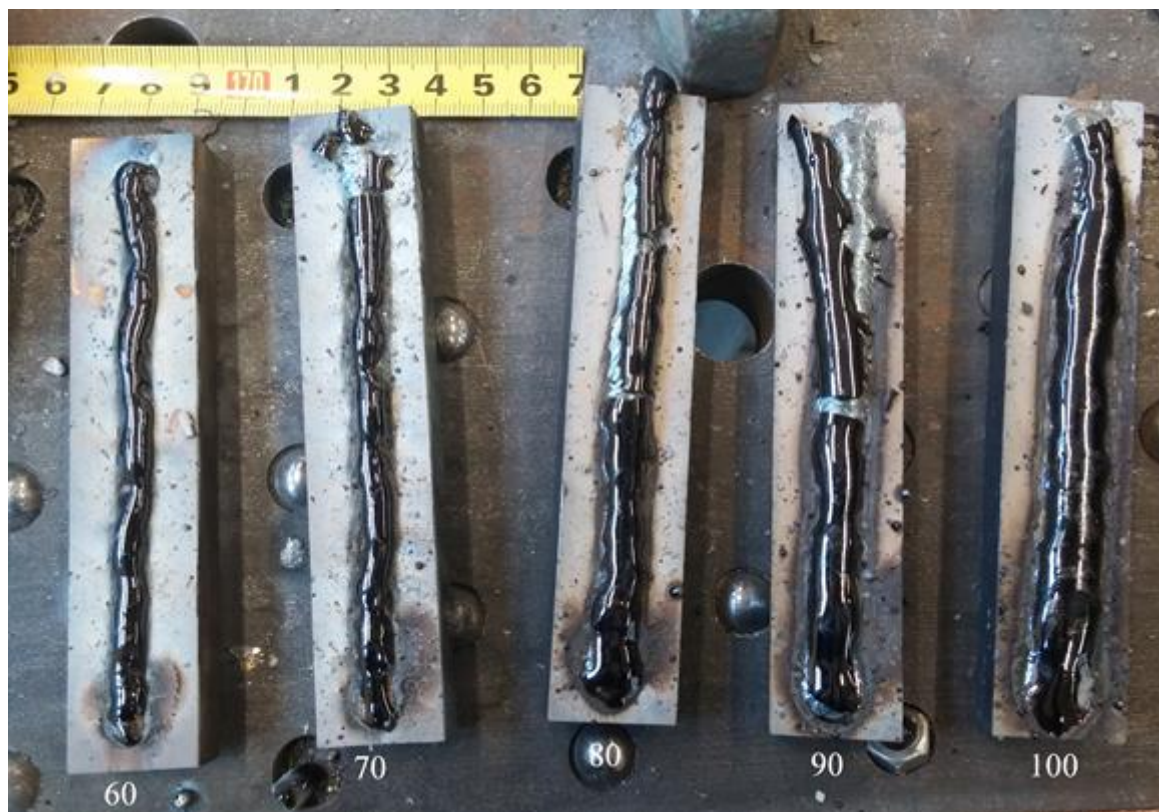
Slika 23. Epruvete nakon zavarivanja - Castoline AC
