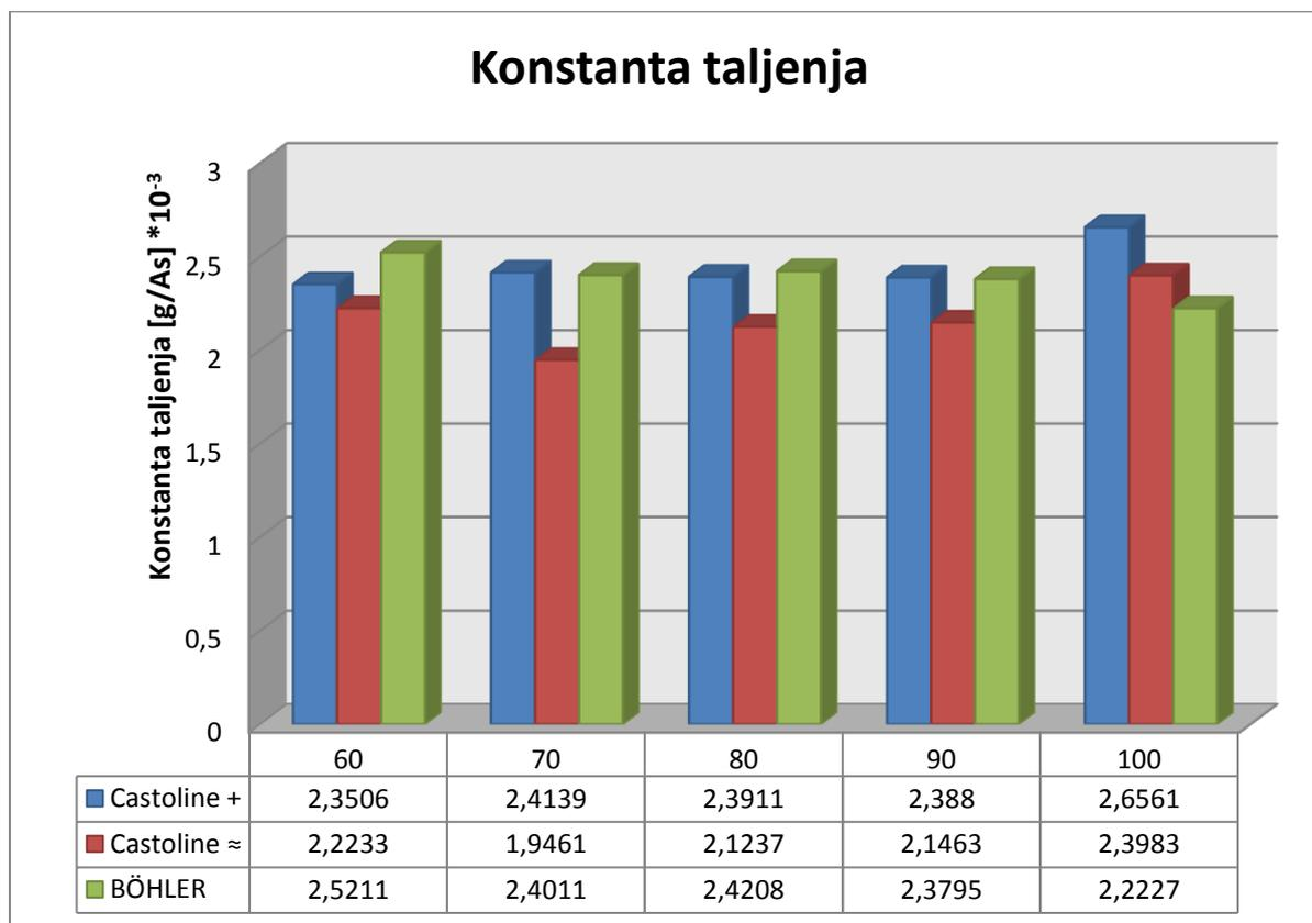
Analizom konstante taljenja se dobiva dijagram vrlo sličan dijagramu učinka neelektrode. Razlika je jedino u tome što uz povećanje struje ne dolazi do povećanja konstante taljenja. Razlog tome je taj što se za izračun konstante taljenja elektrode uz masu istaljenog metala jezgre i vremena zavarivanja uzima u obzir i struja zavarivanja.
