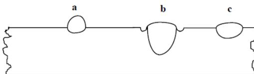
Slika 3. Utjecaj struje zavarivanja na oblik zavara [2]
