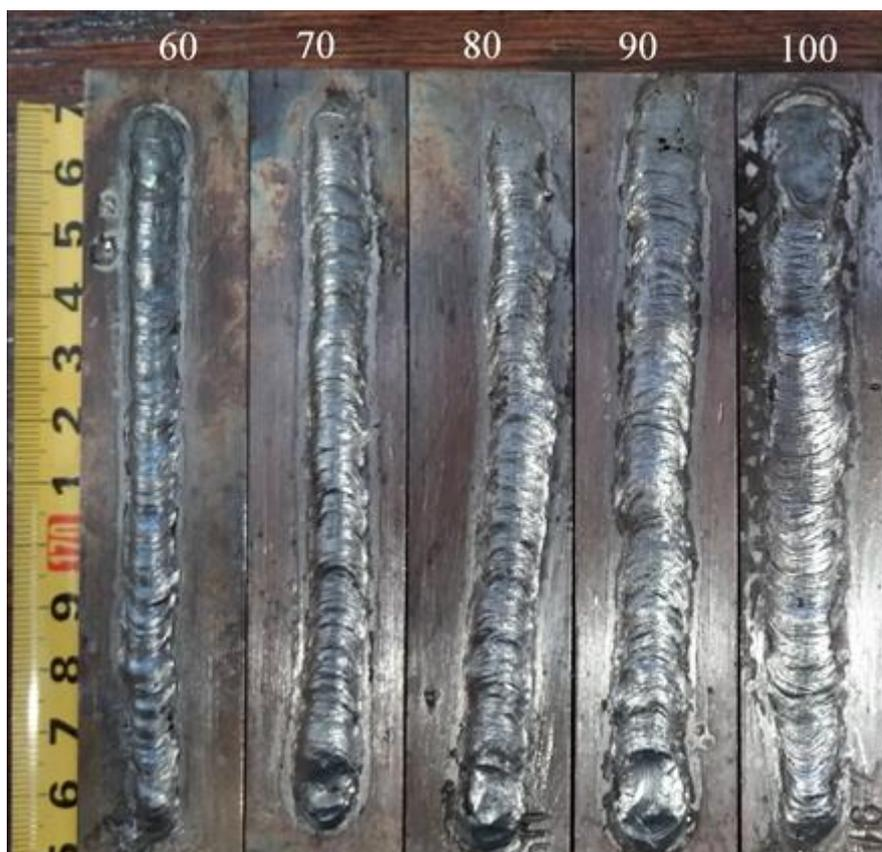
Slika 21. Epruvete nakon čišćenja - Castoline DC(+)
