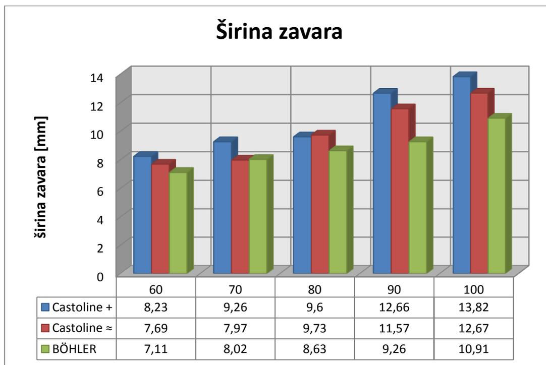
Iz analize širine zavara je vidljivo da Castolinova elektroda ima veću širinu zavara od BÖHLER-ove elektrode. Moguće je uočiti da se pri istosmjernoj struji metal zavara bolje razlijeva i stvara veću širinu zavara uz iste parametre kao i pri izmjeničnoj struji.
