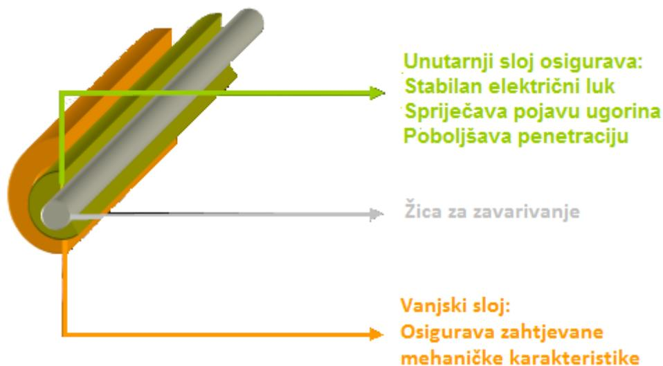
Slika 9. Poprečni presjek dvostruko oplastene elektrode [16]
