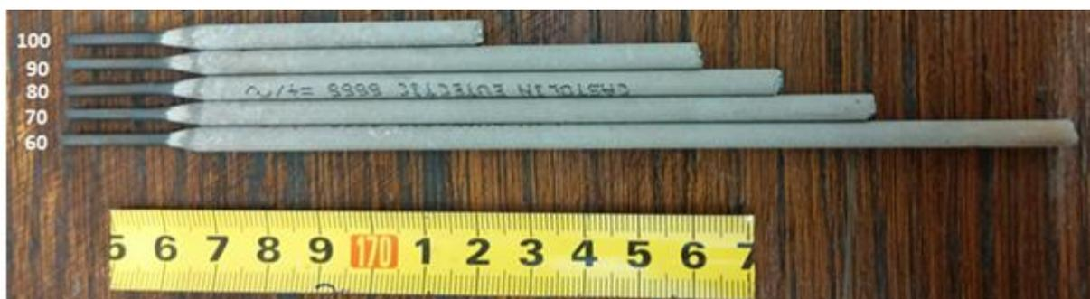
Slika 22. Ostatci Castoline-ovih elektroda nakon zavarivanja - DC(+)
