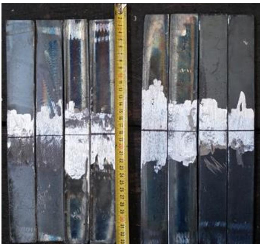
Slika 36. Pripremljeni uzorci za savijanje
