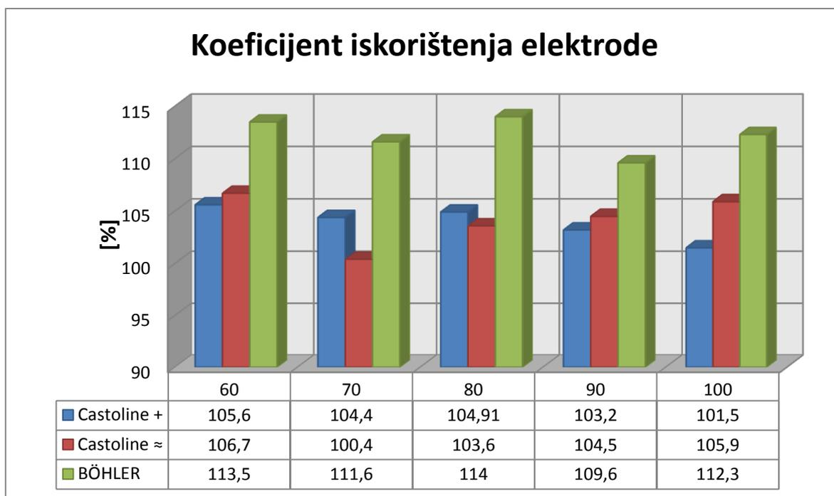
Koeficijent iskorištenja elektrode je omjer količina mase istaljenog metala elektrode, i mase stvarno utrošenog metala jezgre izračenog u postotcima. Za računanje stvarno utrošenog metala jezgre elektrode je izmjerena masa po 3 elektrode od obaju proizvođača te je uzeta srednja vrijednost. Mjerenja su prikazana u tablici 17.
