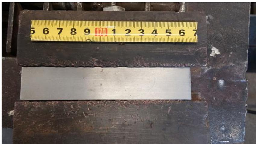
Slika 19. Držač epruvete
