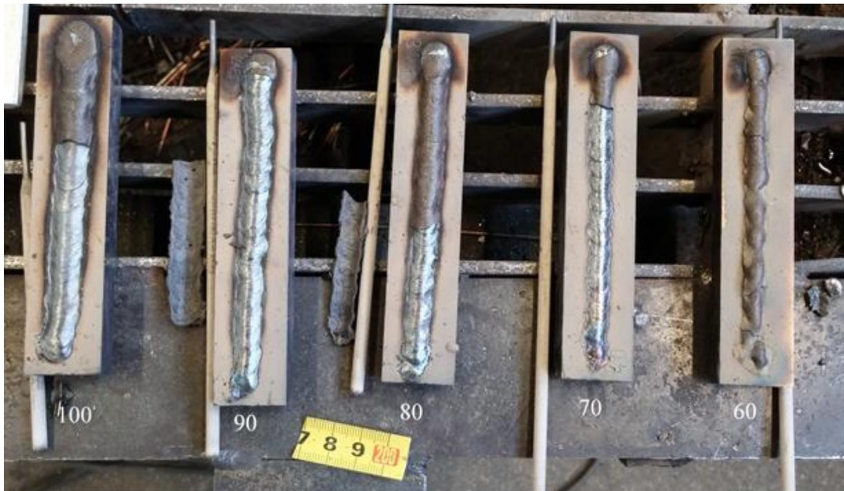
Slika 26. Epruvete nakon zavarivanja - BÖHLER FOX EV 50
