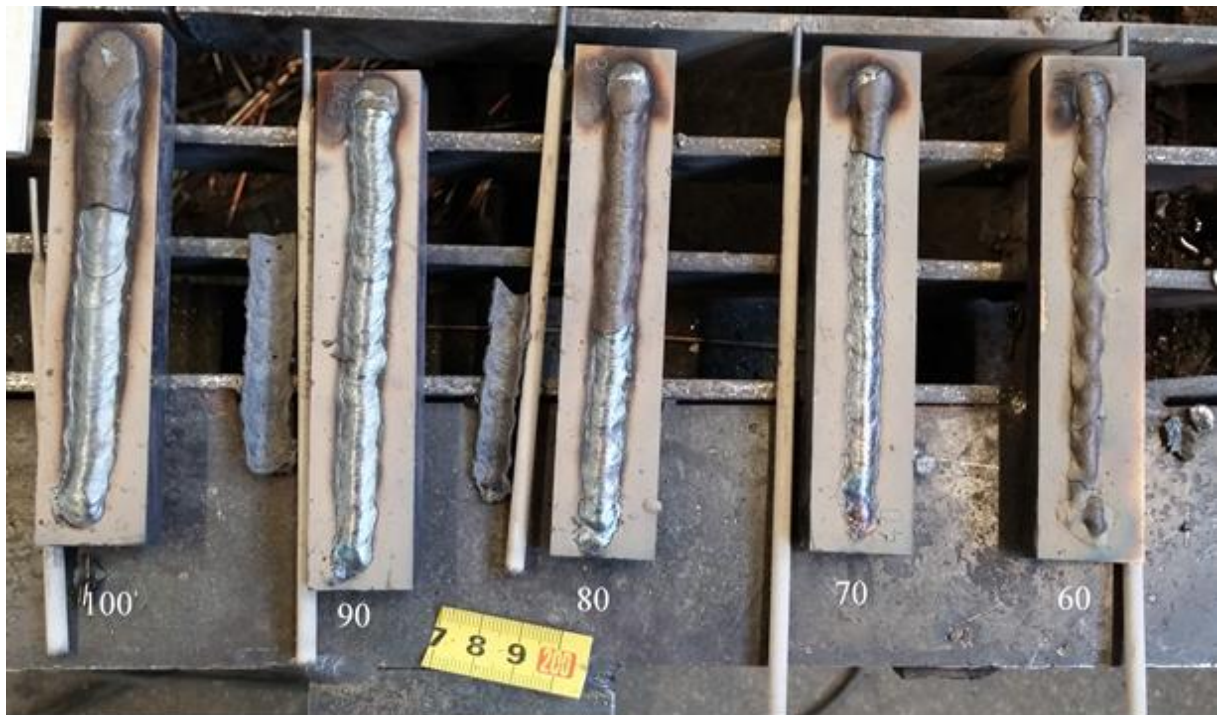
Slika 26. Epruvete nakon zavarivanja - BÖHLER FOX EV 50
