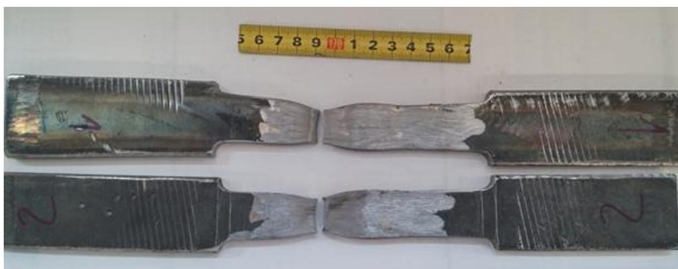
Slika 47. Izgled epruveta nakon statičkog vlačnog pokusa
