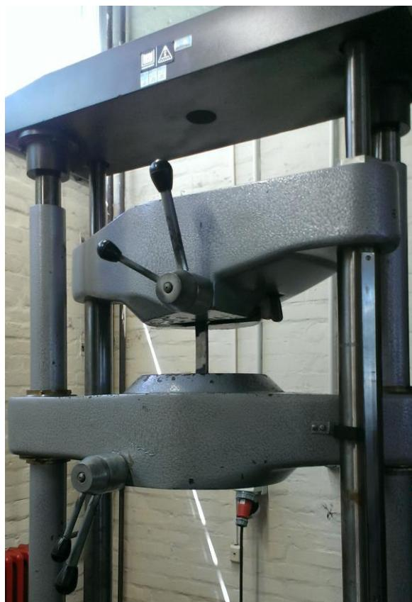
Slika 26 Kidalica EU 40 mod s epruvetom
