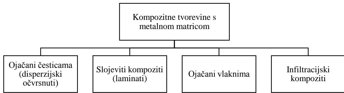
Slika 3. Prikaz klasifikacije kompozita s metalnom matricom [1]
