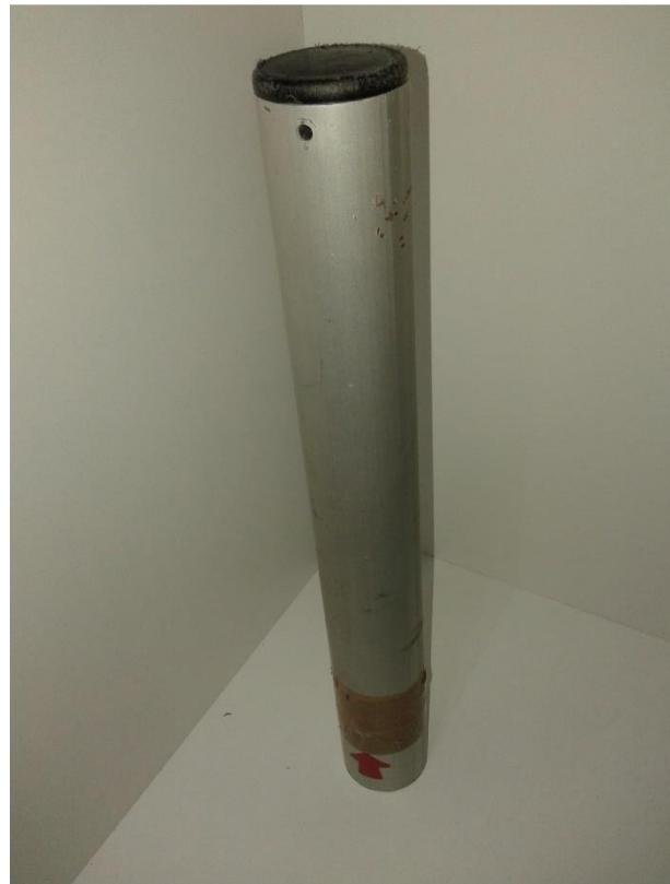
Slika 25. Prikaz dijela jarbola iz kojeg su izrezivane epruvete
