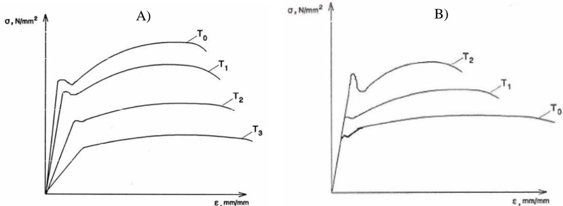
Slika 16. Prikaz na slici (A) prikazuje utjecaj povišenja temperature na  $\sigma$  -  $\epsilon$  dijagram ( $T_3 > T_2 > T_1 > T_0$ ), a (B) utjecaj sniženja temperature na  $\sigma$  -  $\epsilon$  dijagram ( $T_2 < T_1 < T_0$ )
