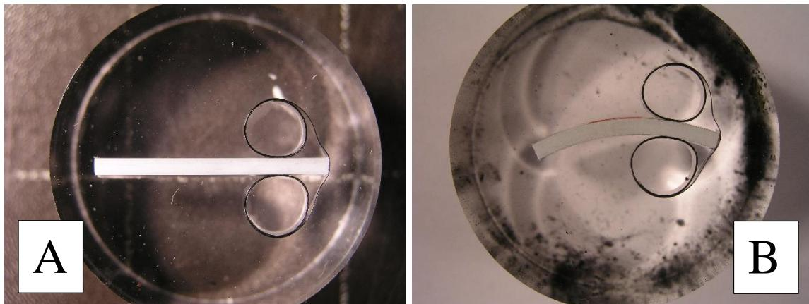
Slika 38. Prikaz zaliivenih uzoraka Al-legure spremnih za metalografsku analizu; A)uzdužno; B)poprečno
