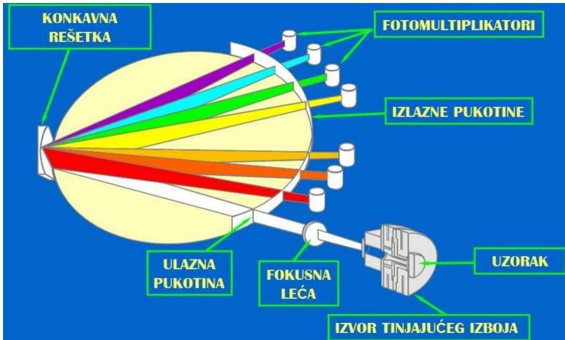
Slika 24. Shematski prikaz spektrometra u GD-OES uređaju [32]
