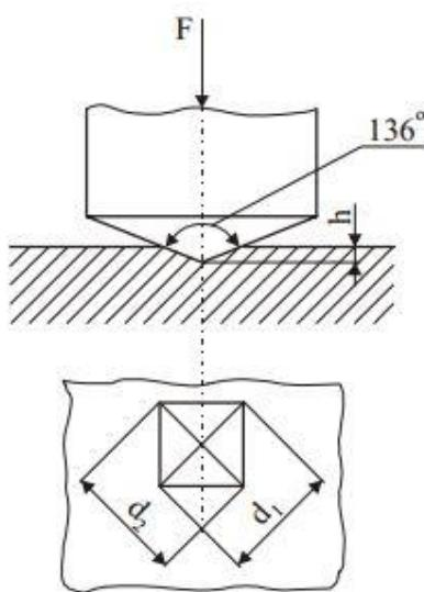
Slika 21. Shematski prikaz indentora i otiska kod ispitivanja tvrdoće po metodi Vickers [31]
