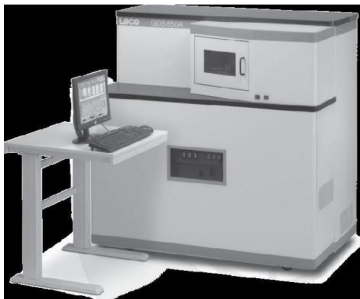
Slika 22. Uređaj za optičku emisijsku spektrometriju s tinjajućim izbojem
