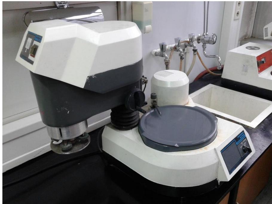
Slika 17. Uredaj na kojem je proveden postupak brušenja ispitnih uzoraka u Laboratoriju za materijalografiju
