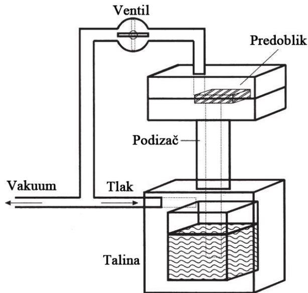
Slika 6. Shematski prikaz postupka infiltracije stlačenim plinom
