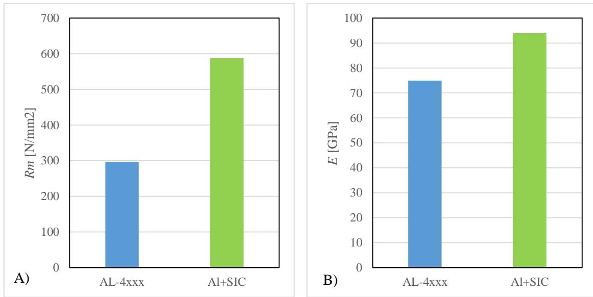
Slika 36. Dijagrami (A) vlačne čvrstoće  $R_m$  i (B) modula elastičnosti  $E$  među uzorcima
