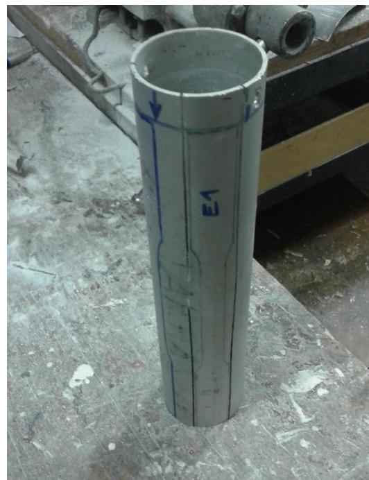
Slika 28. Cijev jarbola s označenim epruvetama za izrezivanje
