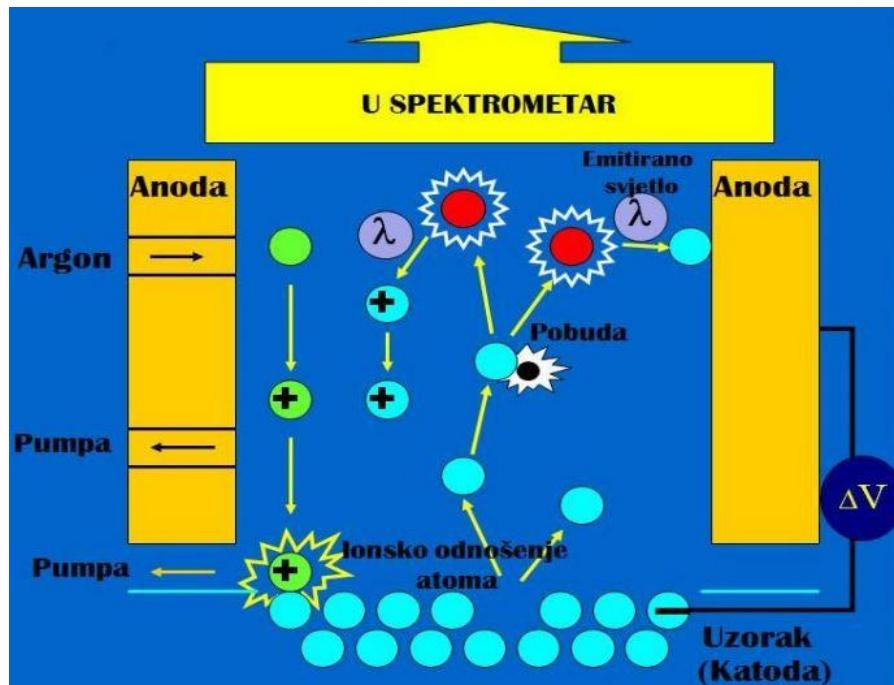
Slika 23. Mehanizam pobude atoma uzorka kod GD-OES analize [32]
