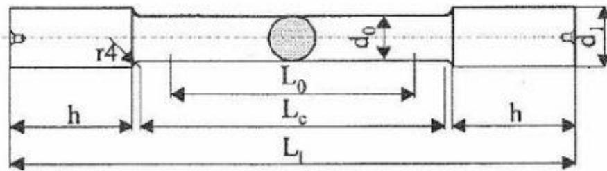
Slika 12. Prikaz uobičajene epruvete za statički vlačni pokus prema normi DIN 50 115;  $L_0$  - početna mjerena duljina,  $d_0$  – početni promjer,  $S_0$  – ploština početnog presjeka [30]
