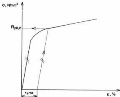
Slika 15. Dijagram naprezanje  $\sigma$  - istezanje  $\epsilon$  za materijale s neizraženim prijelazom iz elastičnog u plastično područje – određivanje konvencionalne granice razvlačenja  $R_{p0,2}$  [30]
