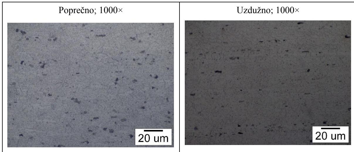
Temeljem uočene mikrostrukture, te uz uporabu Metals Handbook priručnika, zaključuje se da se radi o aluminijskoj leguri serije 4, s toplinskom obradom.
