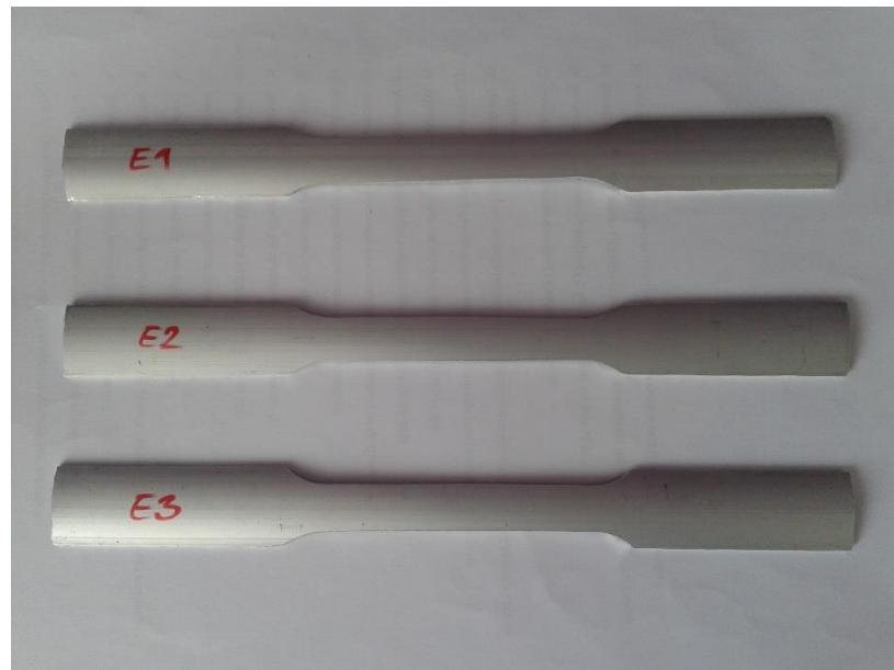
Slika 26. Prikaz epruveta spremnih za mehanička ispitivanja
