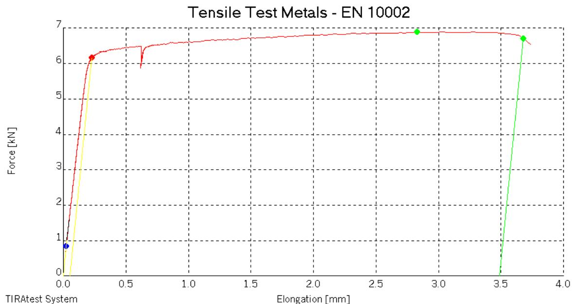
Slika 33. Dijagram Sila - Produljenje za ispitne epruvete.
