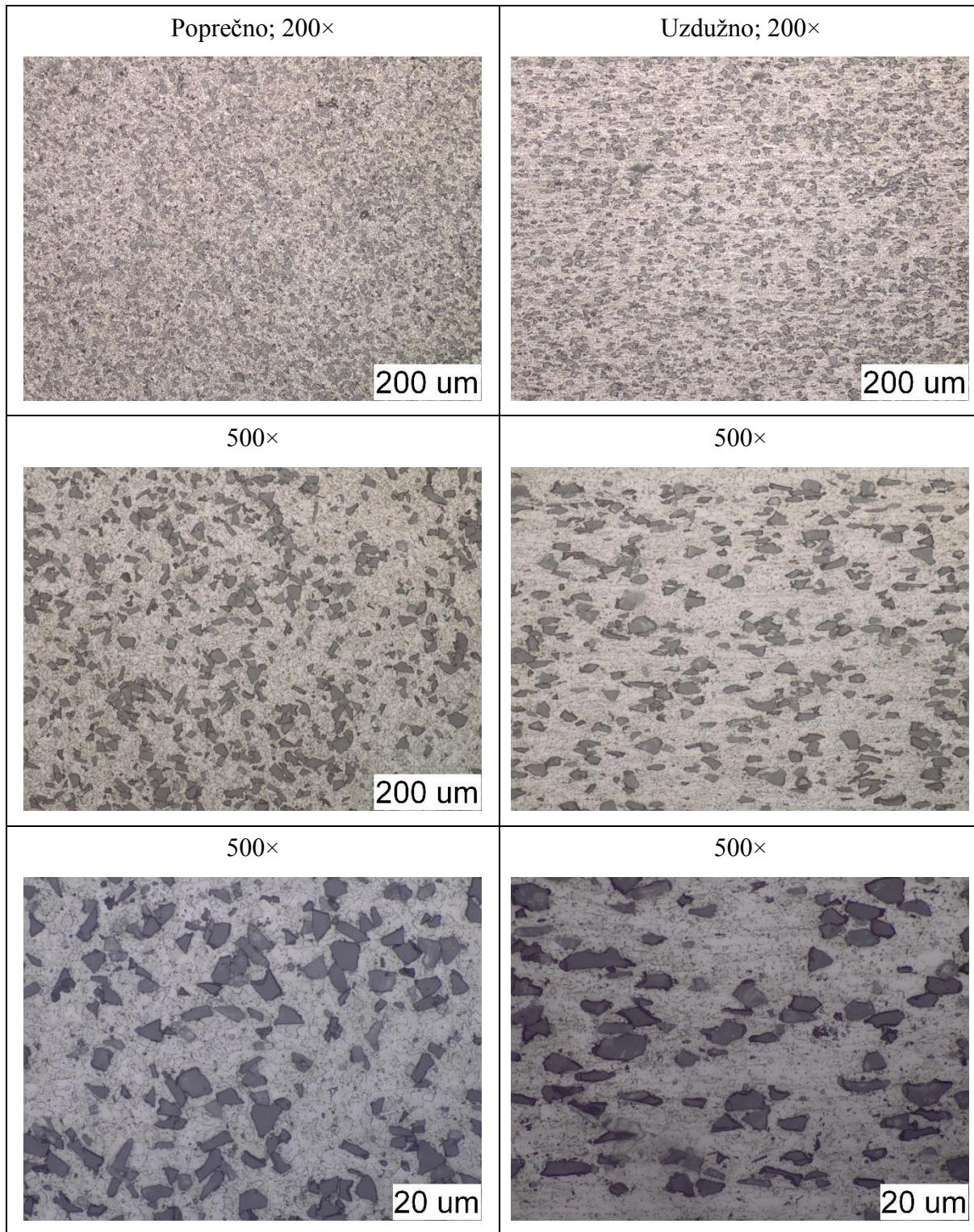
Temeljem analize svjetlosnim mikroskopom, može se uočiti određena usmjerenost strukture s obzirom na smjer ekstrudiranja šipke Al-SiC kompozita.
