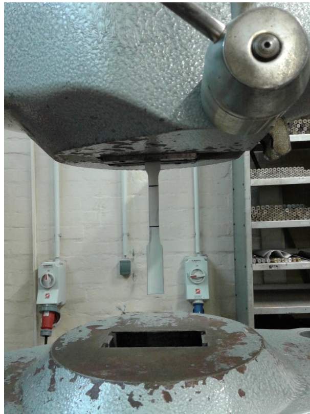
Slika 31. Epruveta s označenom ispitnom duljinom u zahvatu univerzalne kidalice
