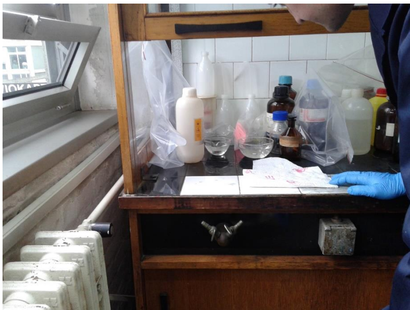
Slika 19. Nagrivanje se obavezno provodi ispod "haube" zbog mogućih štetnih isparavanja
