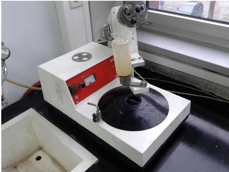
Slika 18. Uređaj na kojem se provodio postupak poliranja ispitnih uzoraka u Laboratoriju za metalografiju
