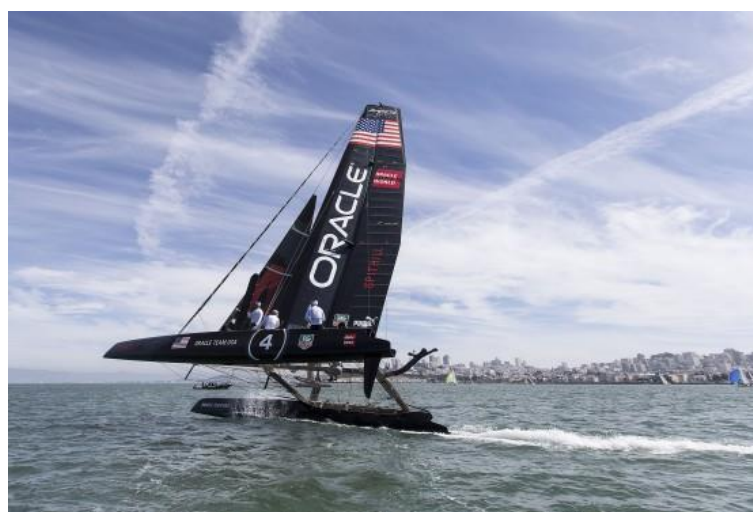
Slika 11. Katamaran sa krutim jedrom i jarbolom od ugljičnih vlakana [29]
