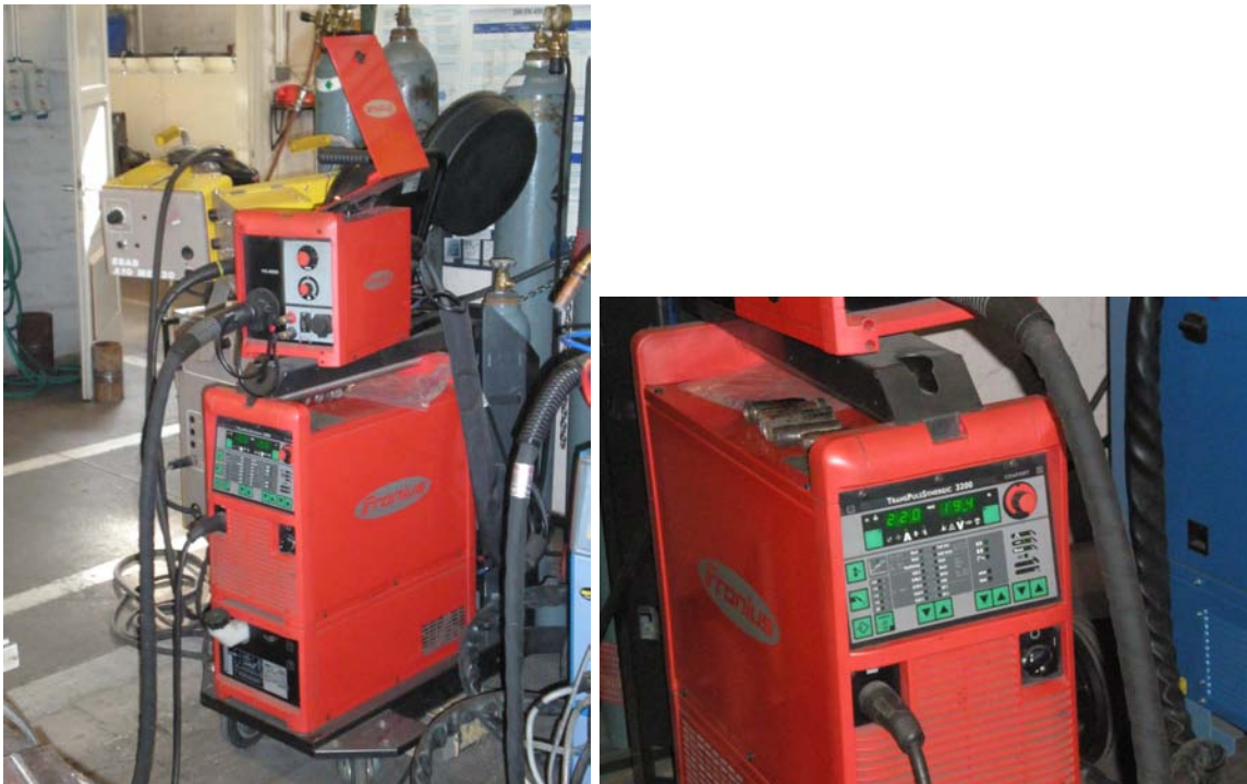
Slika 4.1 „Fronius TransPulse Synergic“ uređaj za zavarivanje
