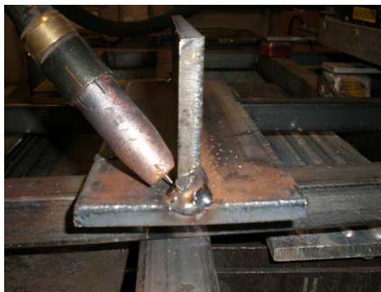
Slika 4.5 Nagib pištolja kod izvođenja kutnog zavara
