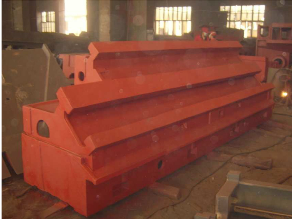
Slika 73. Postolje tokarskog stroja[17]
