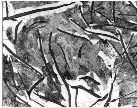
Slika 68. Mikrostruktura perlitno-feritnog sivog lijeva, povećanje 250:1[18]
