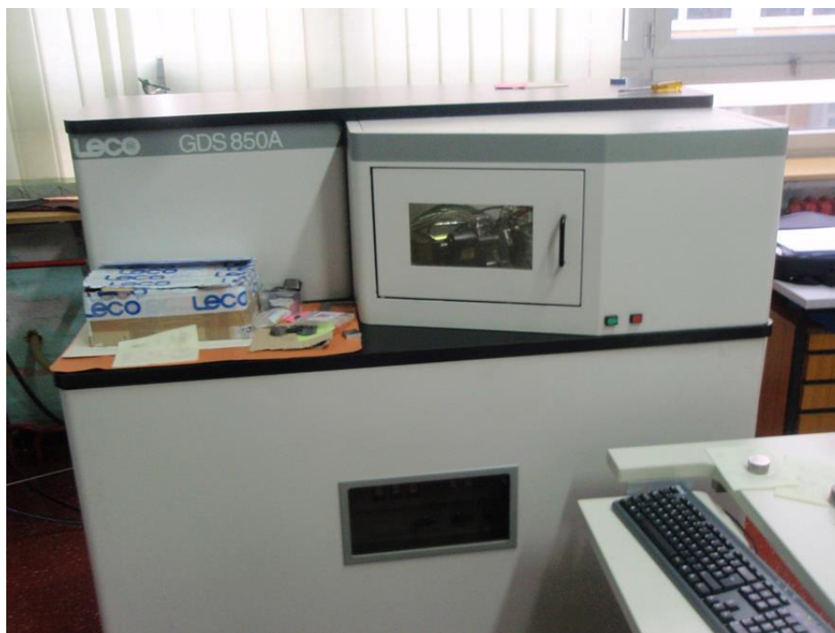
Slika 103. Optički emisijski spektrometar GDS 850A, Leco[33]
