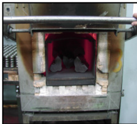
Slika 11. Zagrijavanje polovica kalupa u specijalnoj peći[2]
