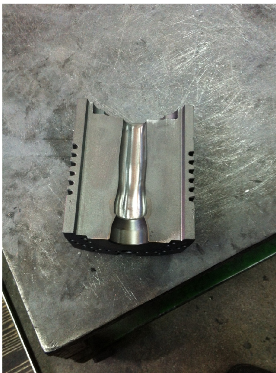
Slika 76. Dio alata za staklenu ambalažu
