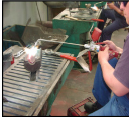
Slika 12. Ručno navarivanje kalupa[2]
