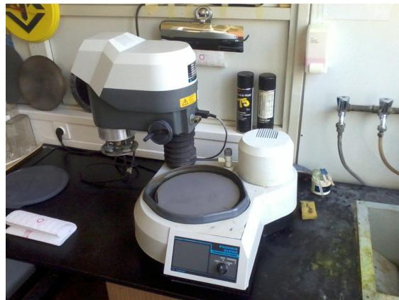
Slika 107. Uređaj za brušenje uzorka
