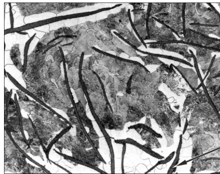
Slika 68. Mikrostruktura perlitno-feritnog sivog lijeva, povećanje 250:1[18]
