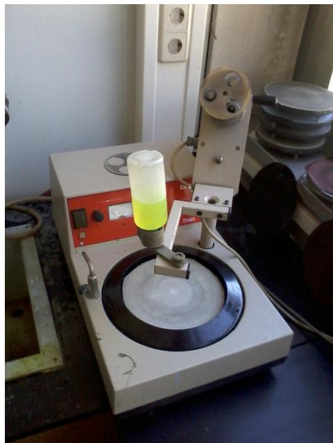
Slika 108. Uređaj za poliranje
