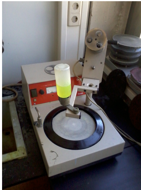
Slika 108. Uređaj za poliranje
