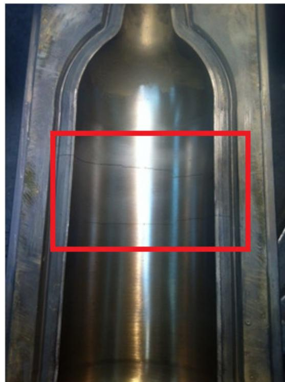
Slika 97. Pukotine kod brončanog kalupa - primjer 2
