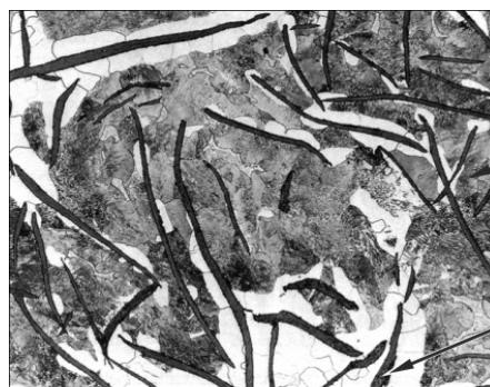
Slika 68. Mikrostruktura perlitno-feritnog sivog lijeva, povećanje 250:1[18]
