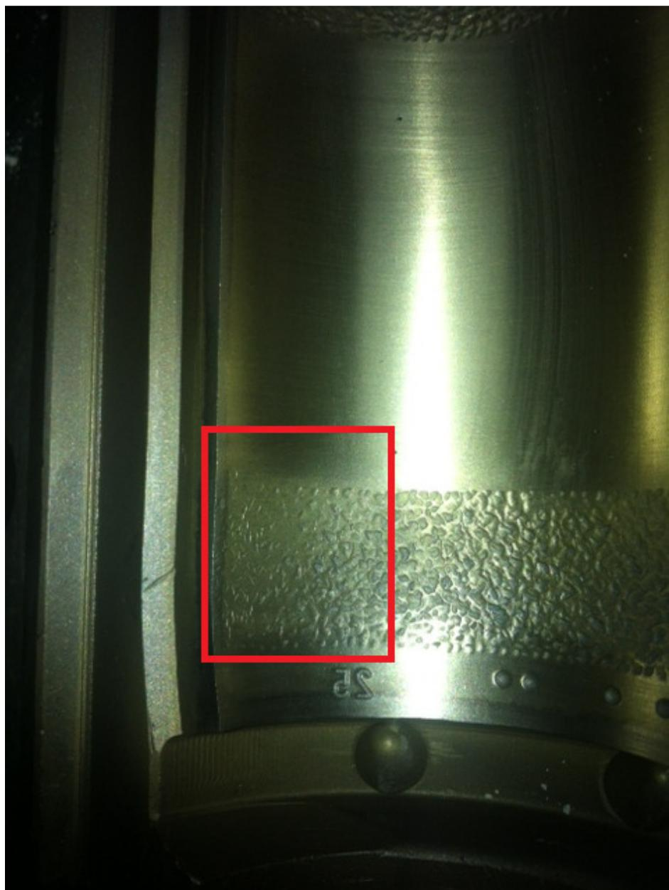
Slika 102. Istrošenost brončanog kalupa za Coctu- primjer 3
