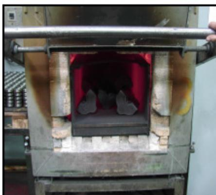
Slika 11. Zagrijavanje polovica kalupa u specijalnoj peći[2]
