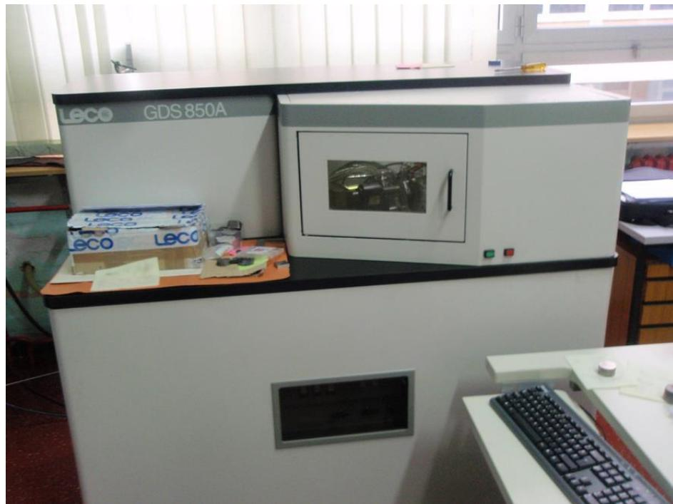
Slika 103. Optički emisijski spektrometar GDS 850A, Leco[33]
