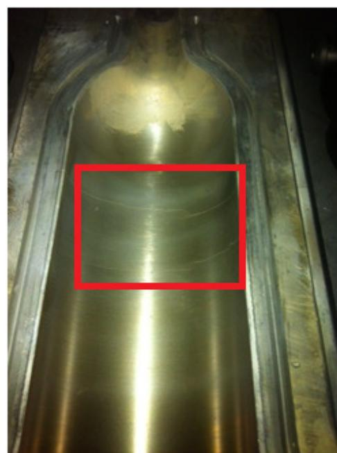
Slika 96. Istrošenost brončanog kalupa- primjer 1
