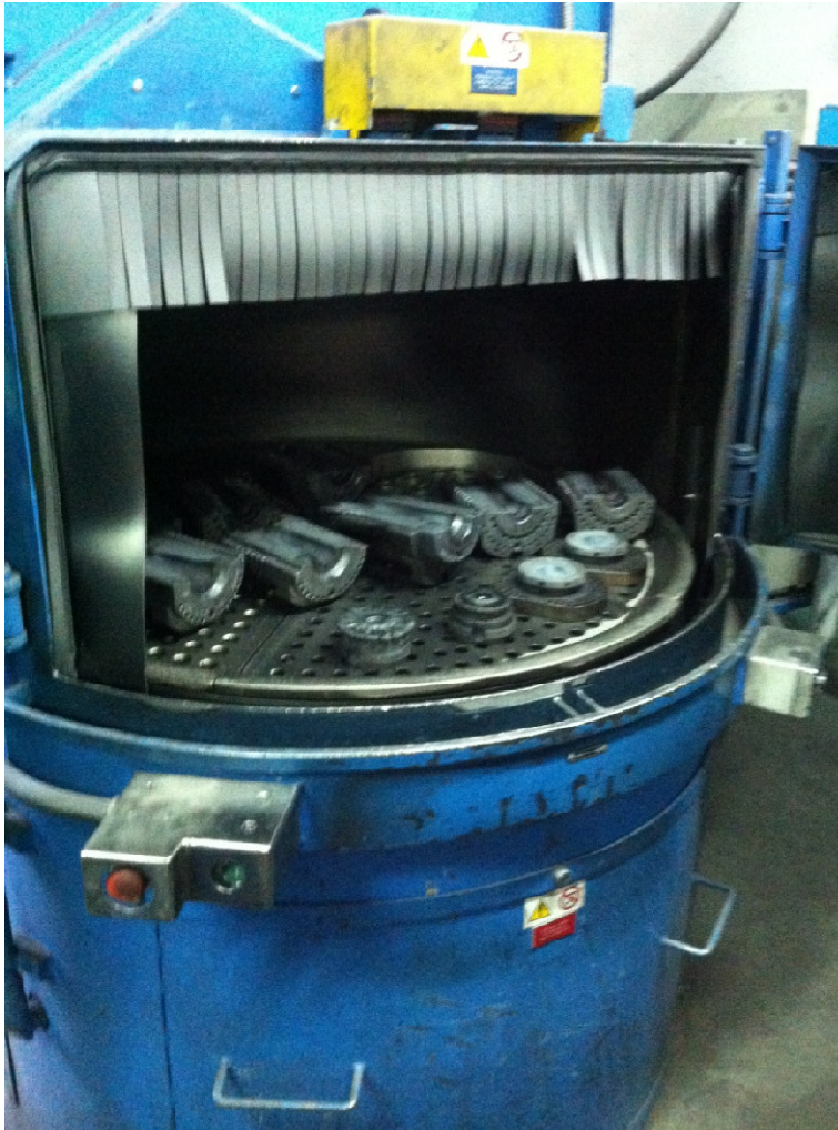
Slika 92. Postupak čišćenja alata
