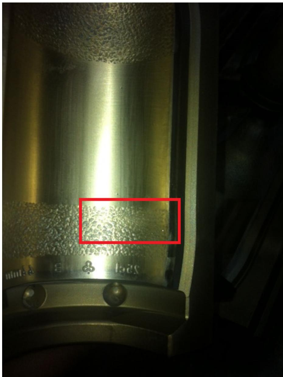
Slika 101. Istrošenost brončanog kalupa za Coctu- primjer 2
