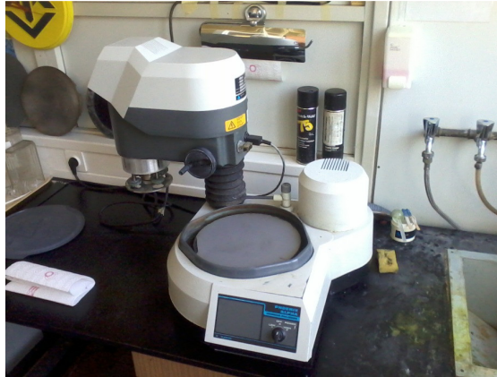
Slika 107. Uređaj za brušenje uzorka
