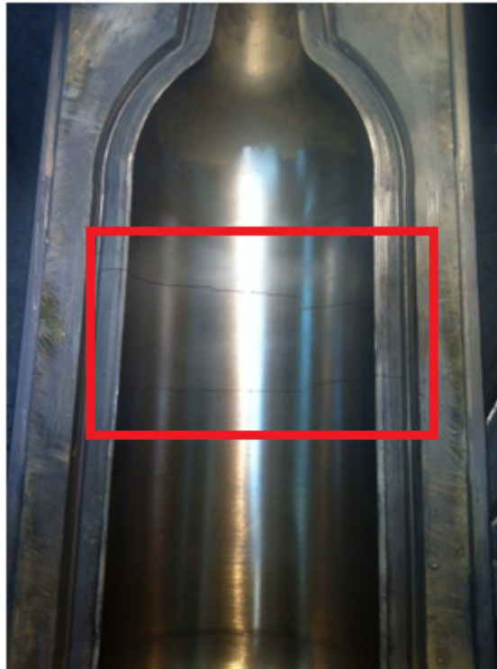
Slika 97. Pukotine kod brončanog kalupa - primjer 2
