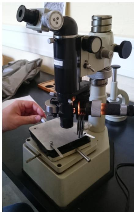
Slika 119. Postupak ispitivanja mikrotvrdoće
