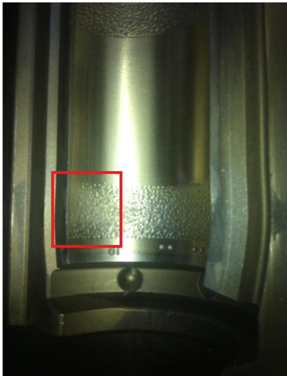
Slika 100. Istrošenost brončanog kalupa za Coctu- primjer 1
