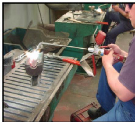
Slika 12. Ručno navarivanje kalupa[2]
