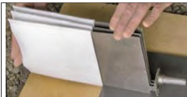
Slika 22 Postavljanje separatora ploča na pozitivne ploče
