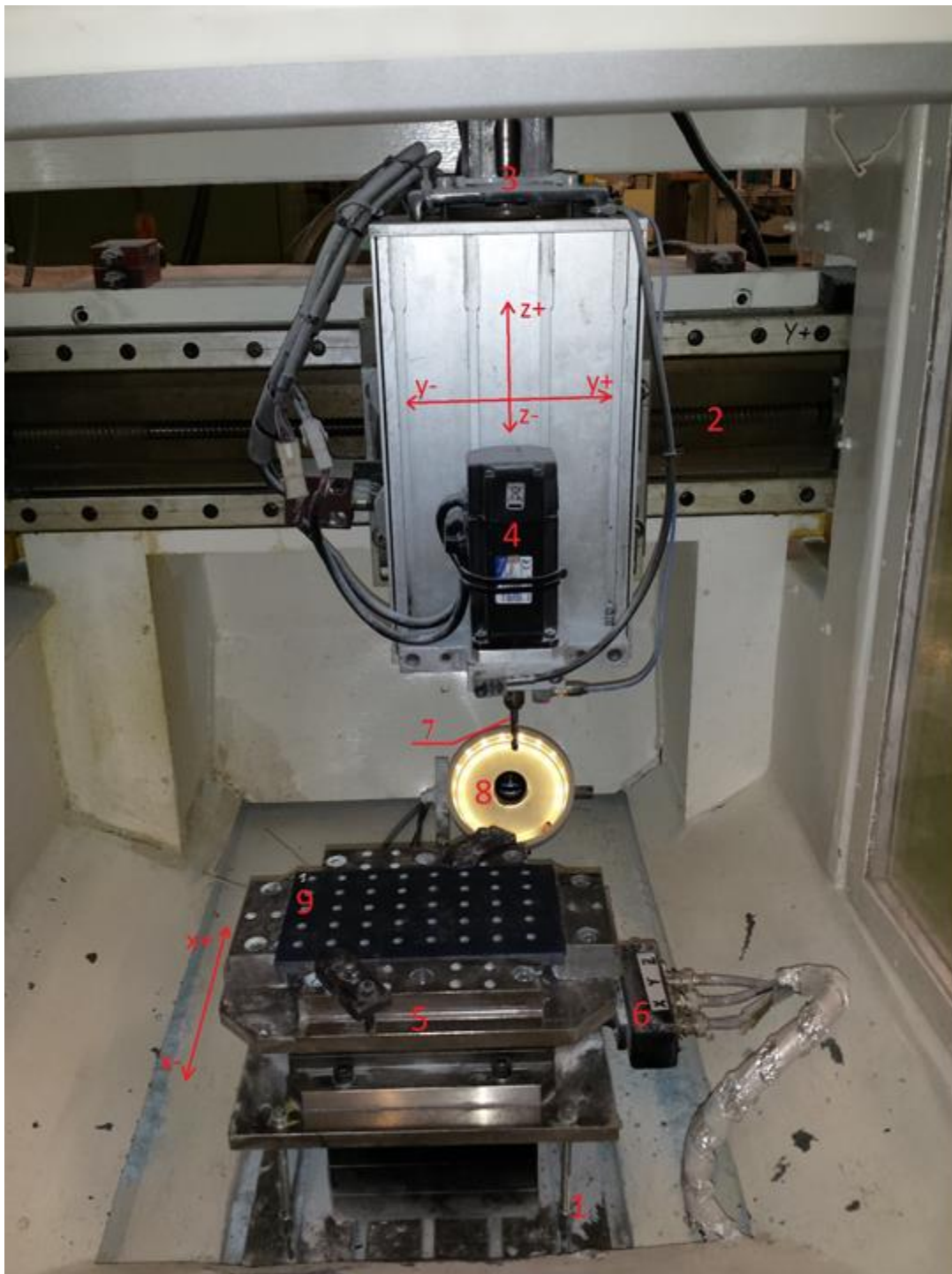
Slika 37 Radni prostor stroja; 1. Posmični prigon X osi, 2. Posmični prigon Y osi, 3. Posmični prigon Z osi, 4. Glavno vreteno, 5. Stezna naprava, 6. Senzor sila, 7. Ispitno svrdlo, 8. Industrijska kamera s rasvjetom, 9. Ispitni uzorak.
