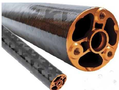
Poluosovina, Chevrolet Corvette C6, 52% manja masa od serijske, višestruko izdržljivija, cijena 2000$
