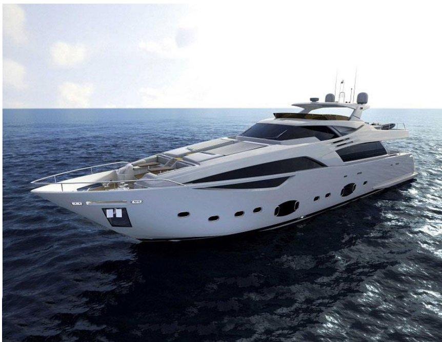
Slika 7 Jahta duljine 30,6 m izrađena od polimernog kompozita ojačanog staklenim vlaknima; Ferretti Custom line 100 [13]
