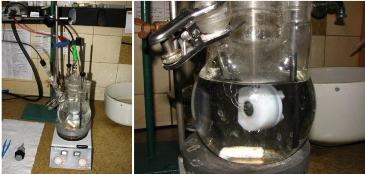
Slika 27. Ispitna ćelija (lijevo), radna elektroda/ispitivani uzorak u nosaču (desno) [22]
