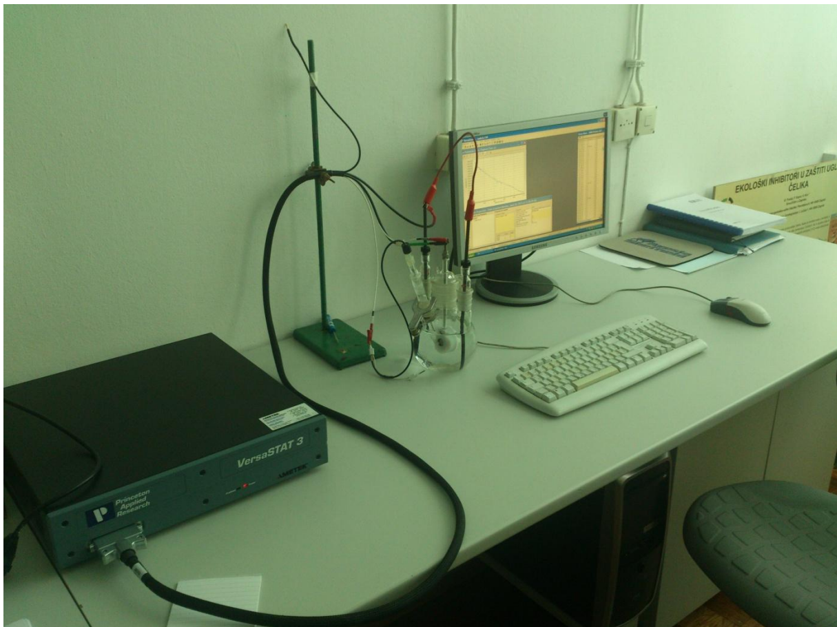
Slika 32. Oprema za EIS ispitivanja
