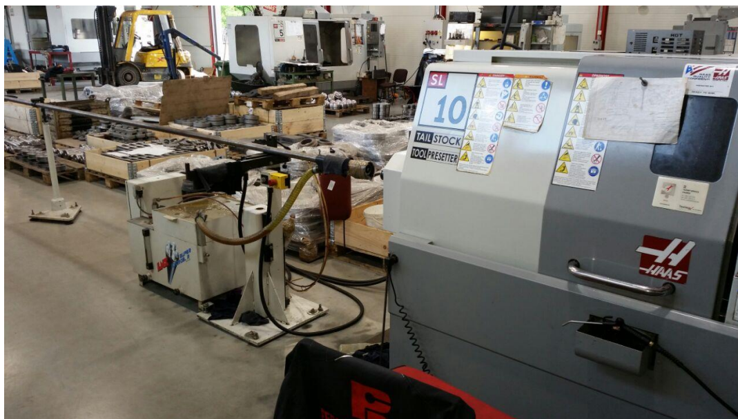
Slika 34. CNC tokarilica HAAS SL 10 sa automatskim dodavačem šipki
