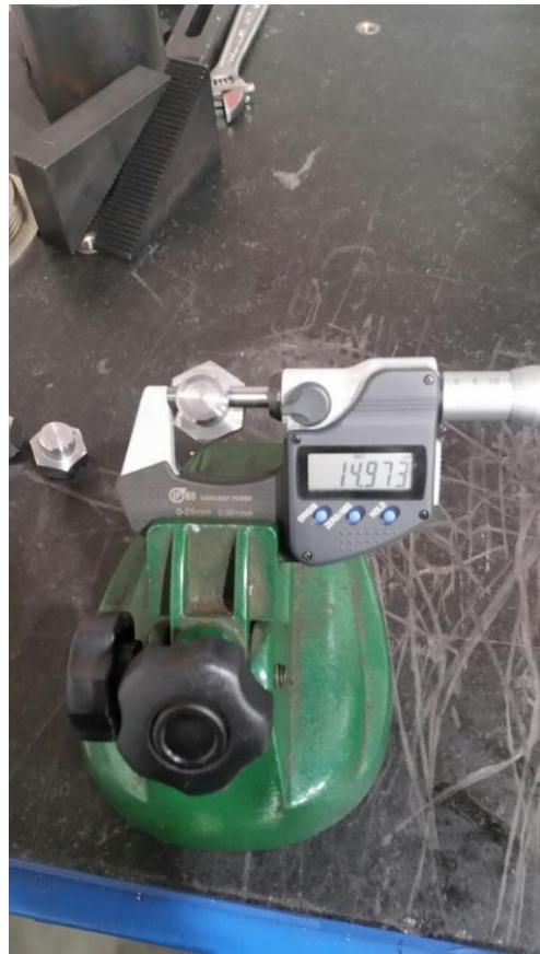
Slika 38. Mjerni instrument digitalni mikrometar
