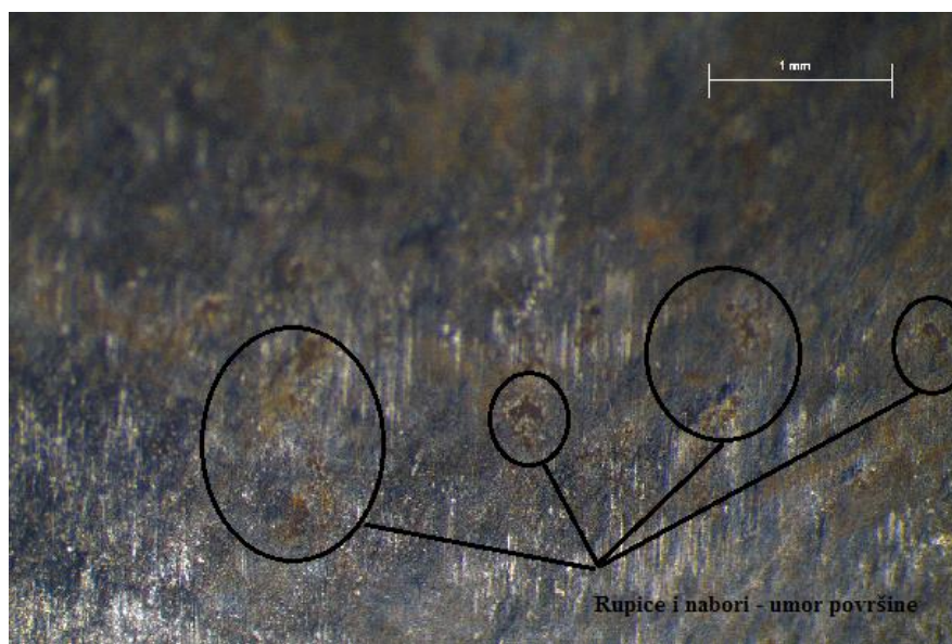
Slika 65. Rupice nastale umorom površine - brijegovi
