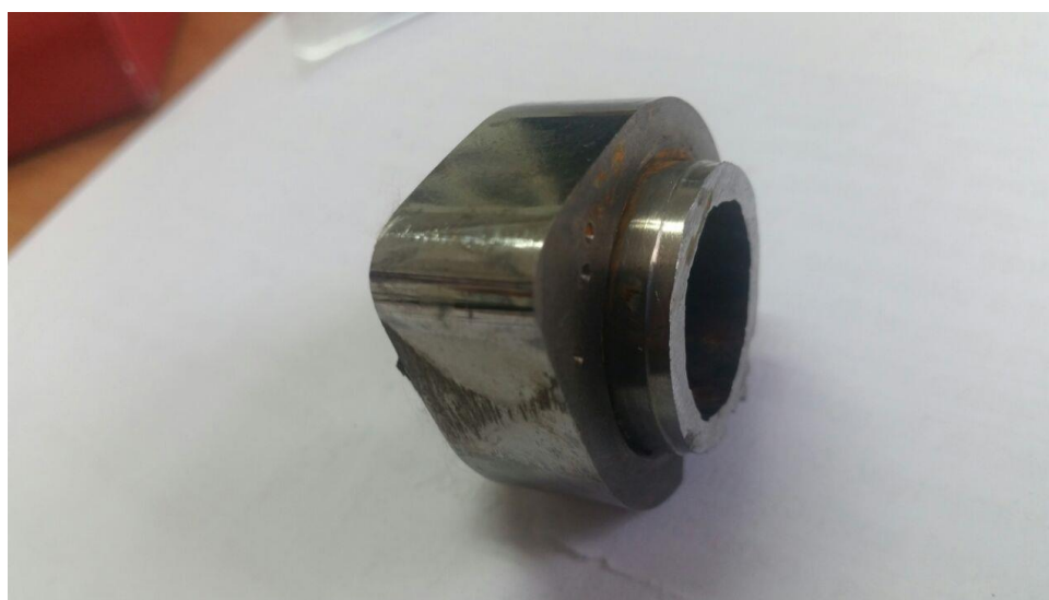
Slika 51. Najoštećeniji brijeg – ispitni uzorak
