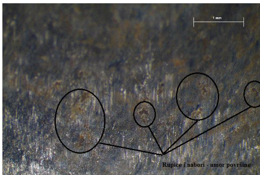
Slika 65. Rupice nastale umorom površine - brijegovi
