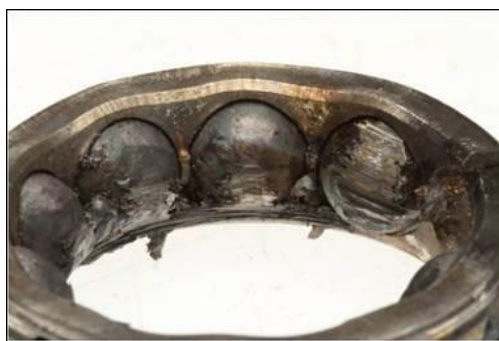
Slika 23. Primjer nepoželjnog djelovanja trenja [23]
