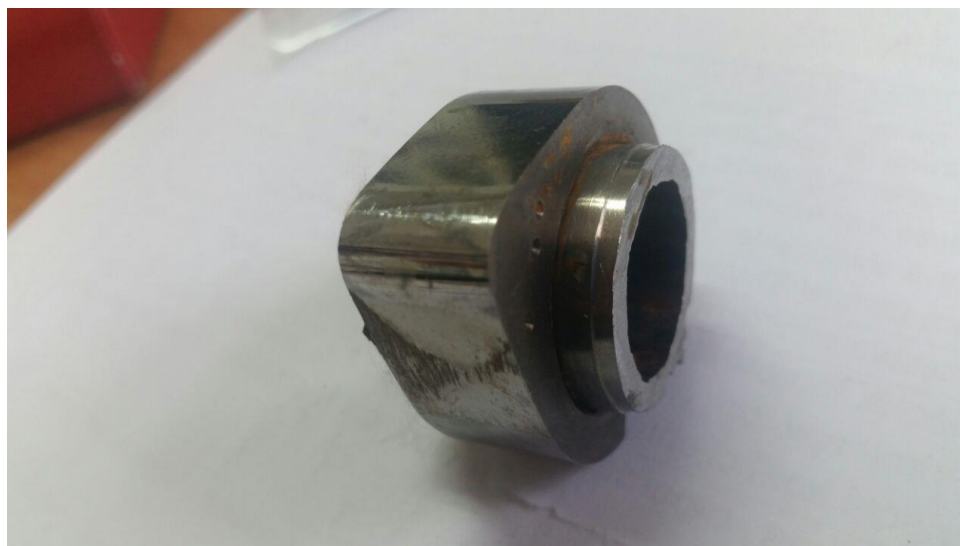
Slika 51. Najoštećeniji brijeg – ispitni uzorak
