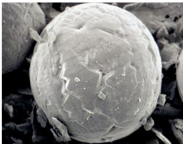
Slika 47. Kuglasta čestica trošenja nastala umorom površine [27]
