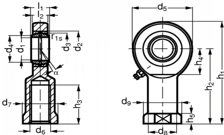
**Tablica 16.** Dimenziije odabrane zglobne glave hidrauličkog cilindra
