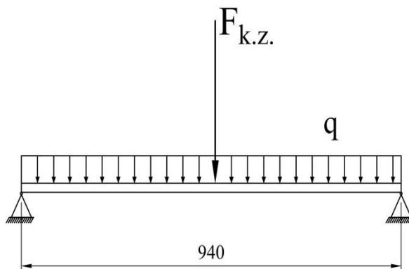
**Slika 19. Prikaz djelovanja sila na sekundarni nosač 1 (3)**
