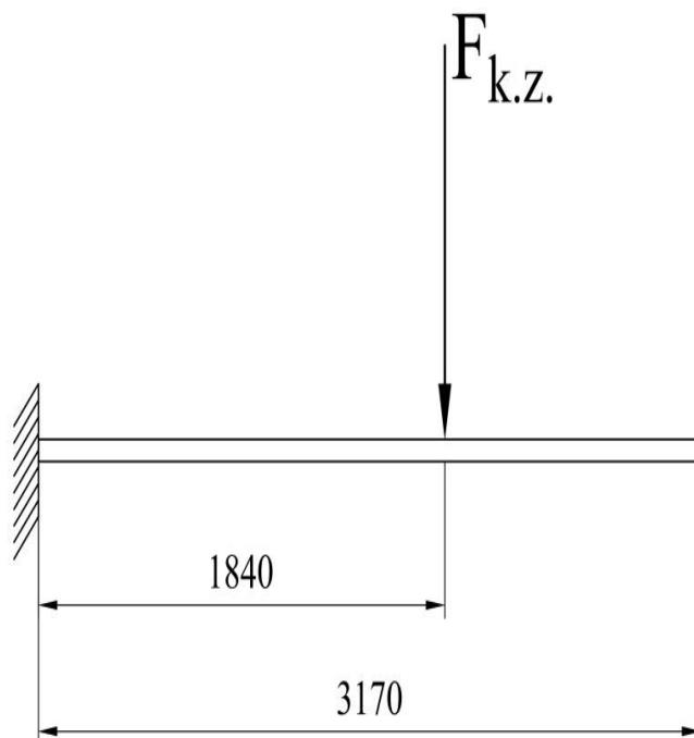
Slika 26. Prikaz dijelovanja sile na rubni konzolni nosač 1 (7)
