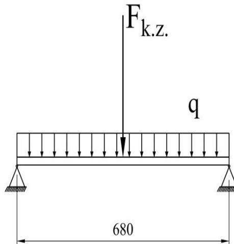
Slika 22. Prikaz djelovanja sila na sekundarni nosač 4 (3)
