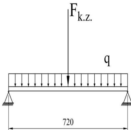
Slika 21. Prikaz djelovanja sila na sekundarni nosač 3 (3)
