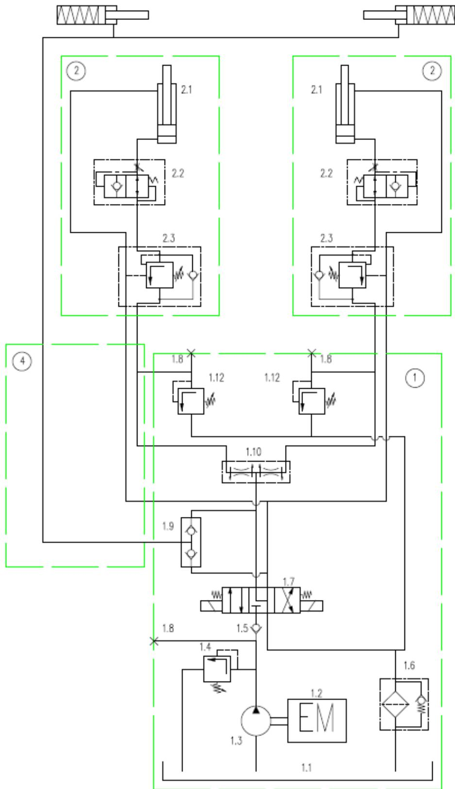
Slika 37. Shema spajanja hidrauličkog cilindra
