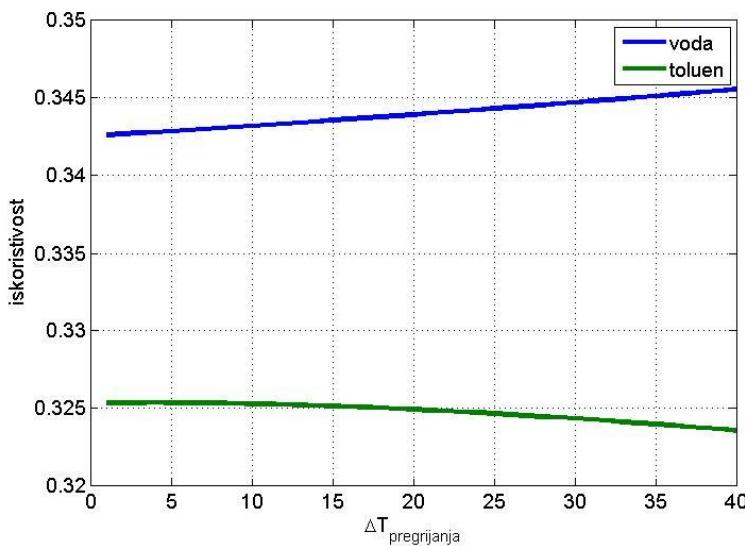
Slika 1 : Ovisnost termodinamičke iskoristivosti i temperature pregrijanja kod vode i toluenea
