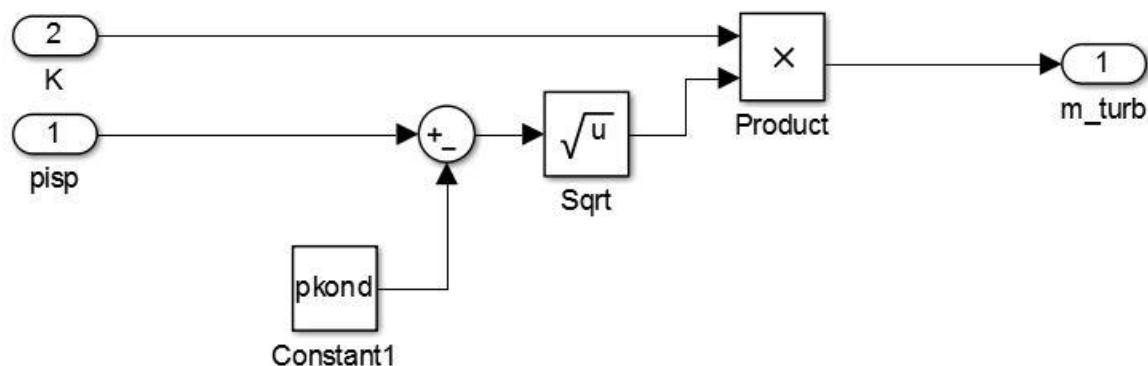
Slika 29: Simulink shema turbine – iznutra
