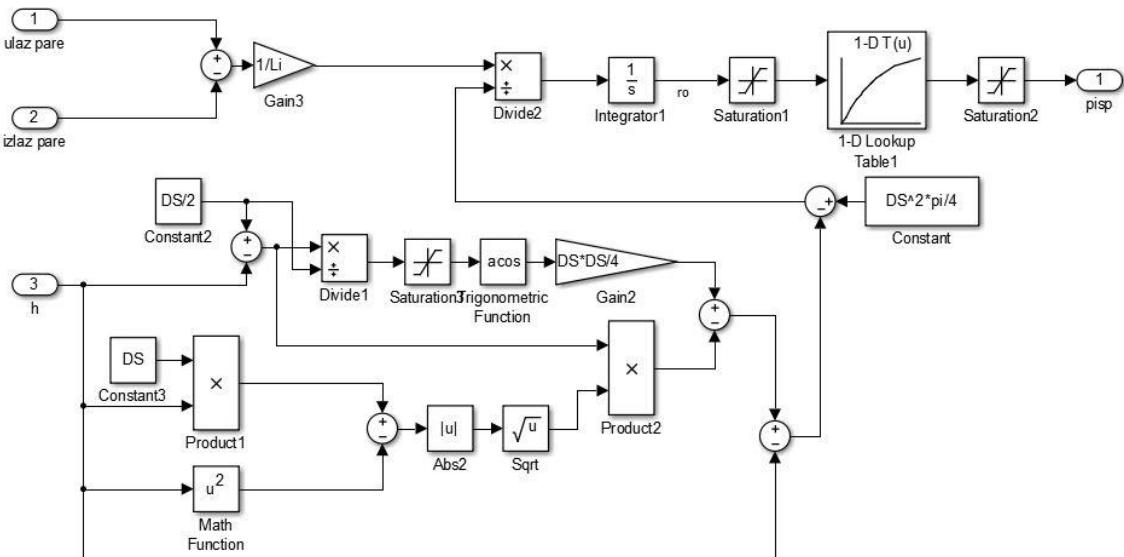
Slika 27: Simulink shema parnog volumena
