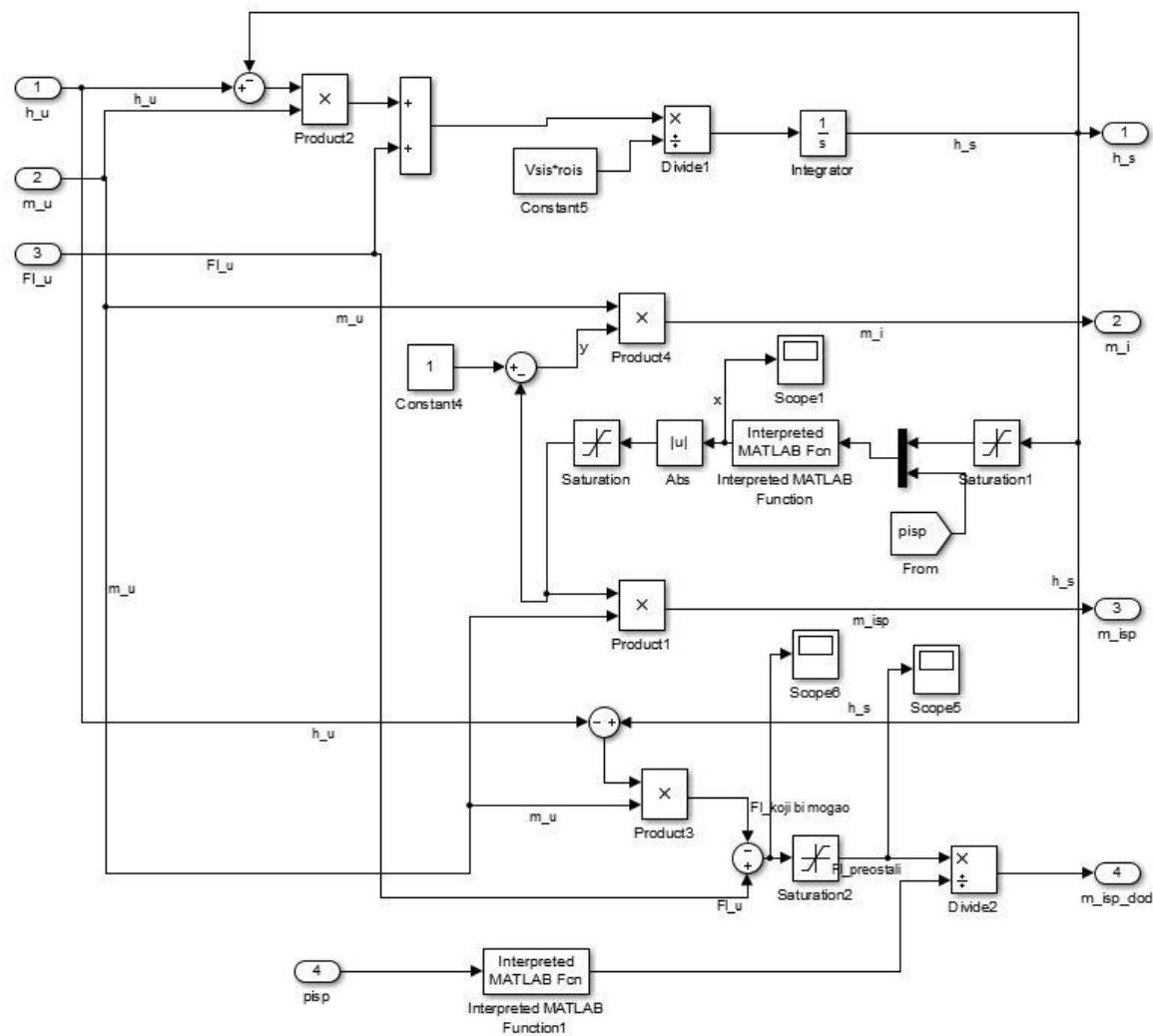
Slika 39: Simulink shema segmenta isparivača – strana RM
