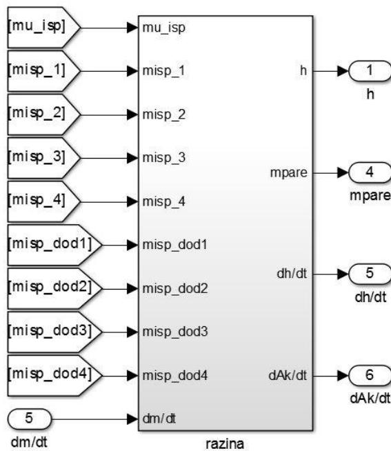
Slika 36: Simulink shema isparivača – razina – izvana
