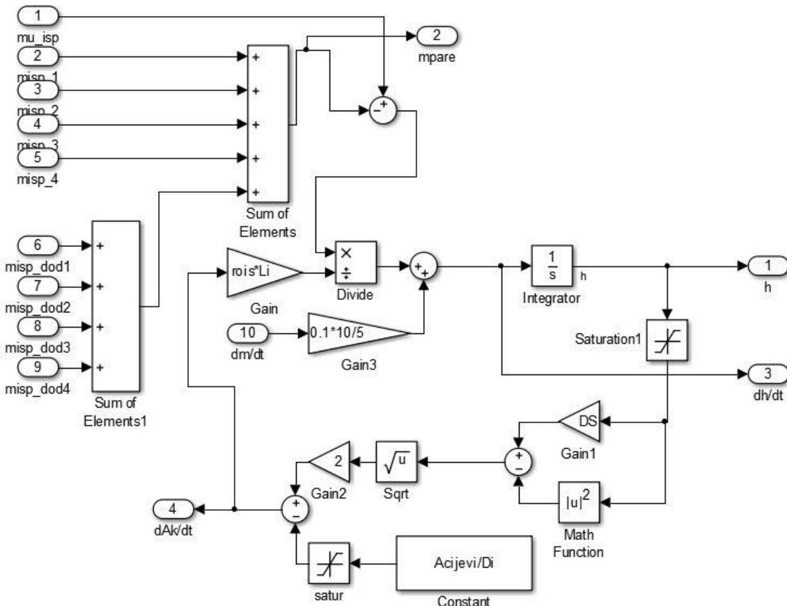
Slika 37: Simulink shema isparivača – razina – iznutra
