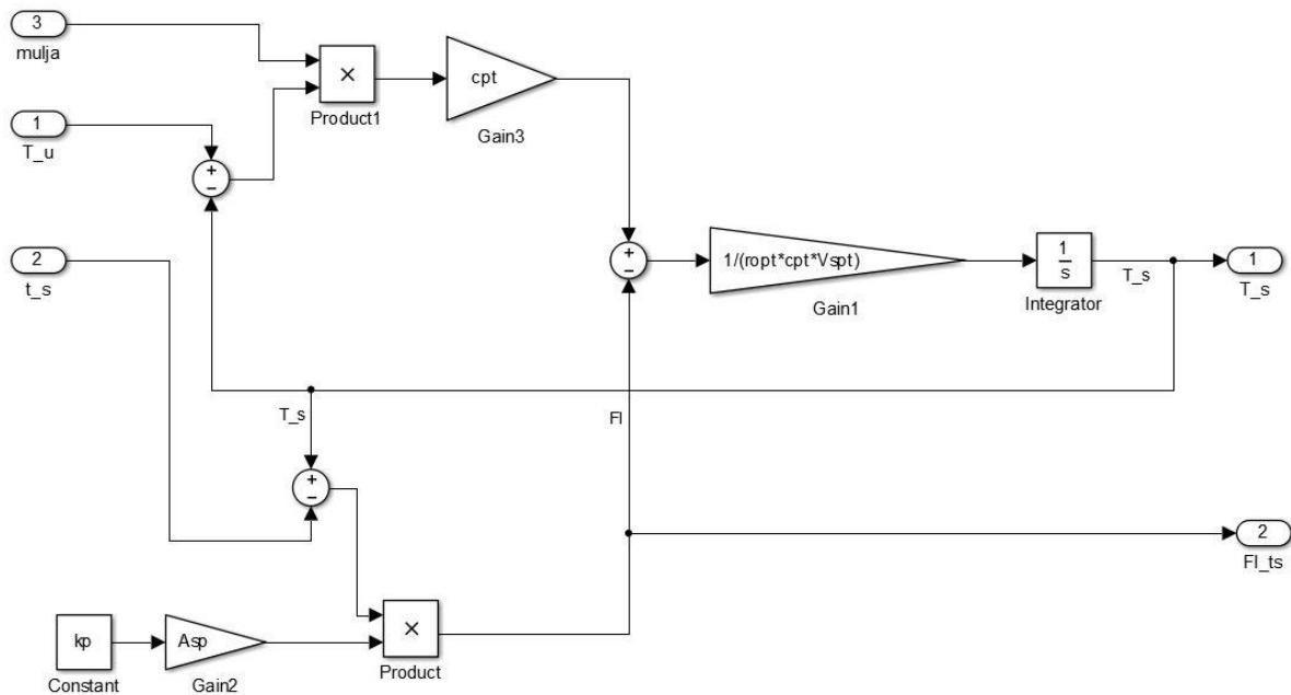
Slika 42: Simulink shema segmenta pregrijača – strana OM
