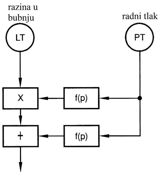
**Slika 5: Mjerenje razine uz kompenzaciju tlaka\*** [8]
