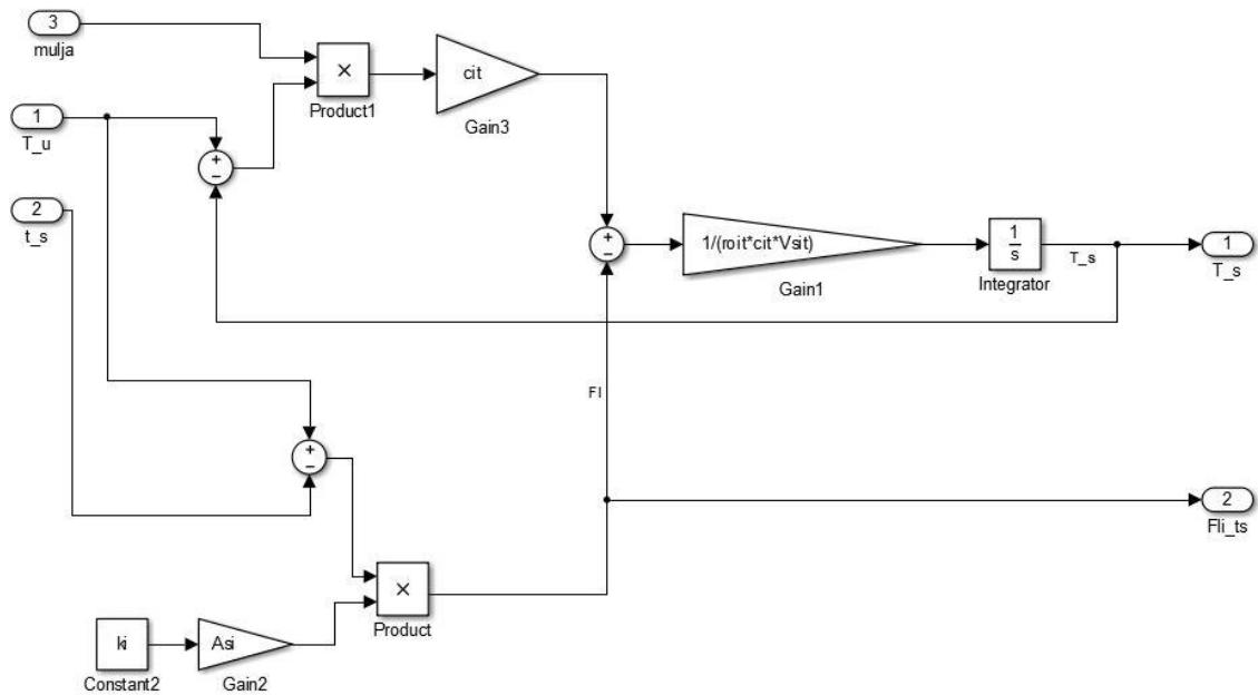
Slika 38: Simulink shema segmenta isparivača – strana OM
