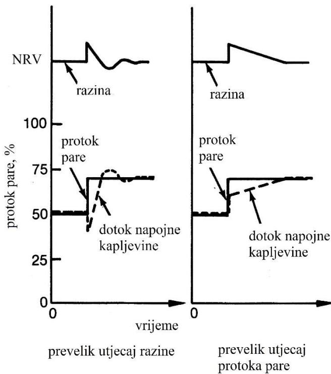
**Slika 7: Utjecaj parametara na regulaciju protoka napojne vode [8]**
