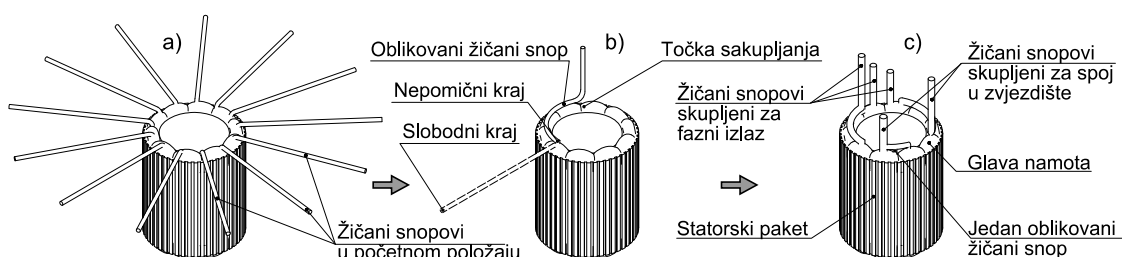
Slika 2. Proces oblikovanja žičanih snopova
