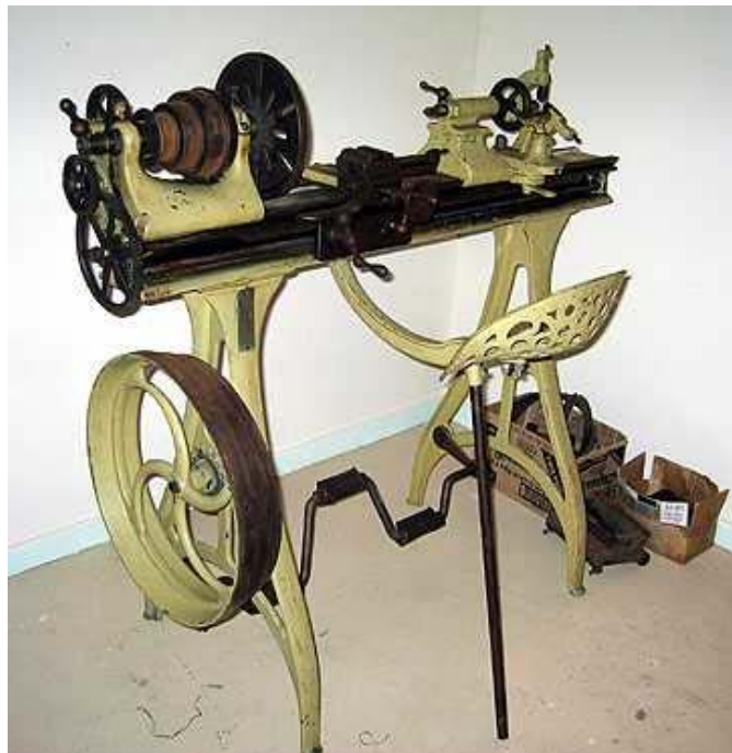
Slika 2.1. Jedan od prvih tokarskih strojeva pokretan ljudskom snagom [4]
