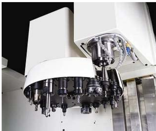
Slika 3.4. Prikaz automatske izmjene alata [12]
