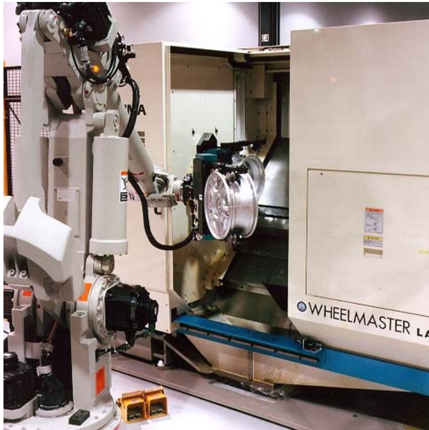
Slika 4.3. Robot skida obradak sa CNC stroja [18]
