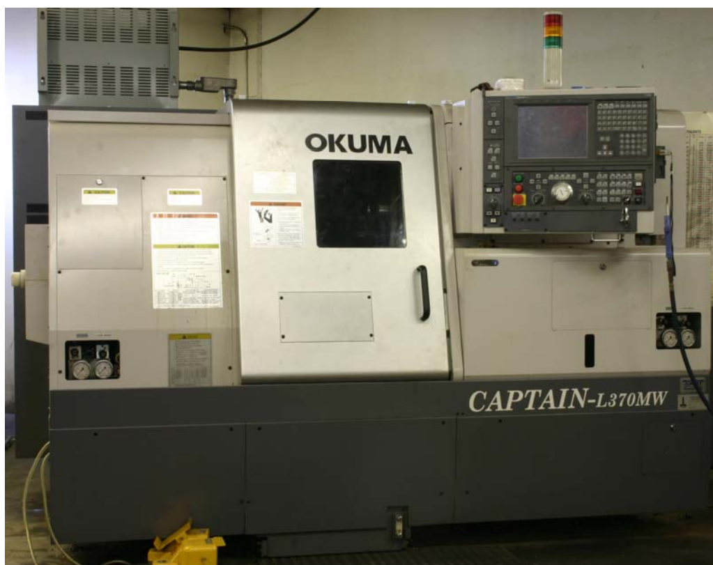
Slika 2.2. Suvremeni CNC tokarski obradni centar [5]
