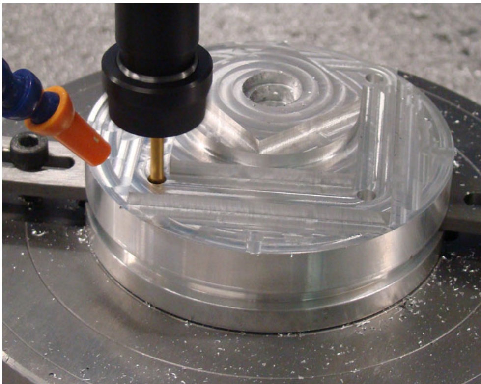
Slika 5.24. Obradivanje testnog izratka na laboratorijskom SCARA robotu
