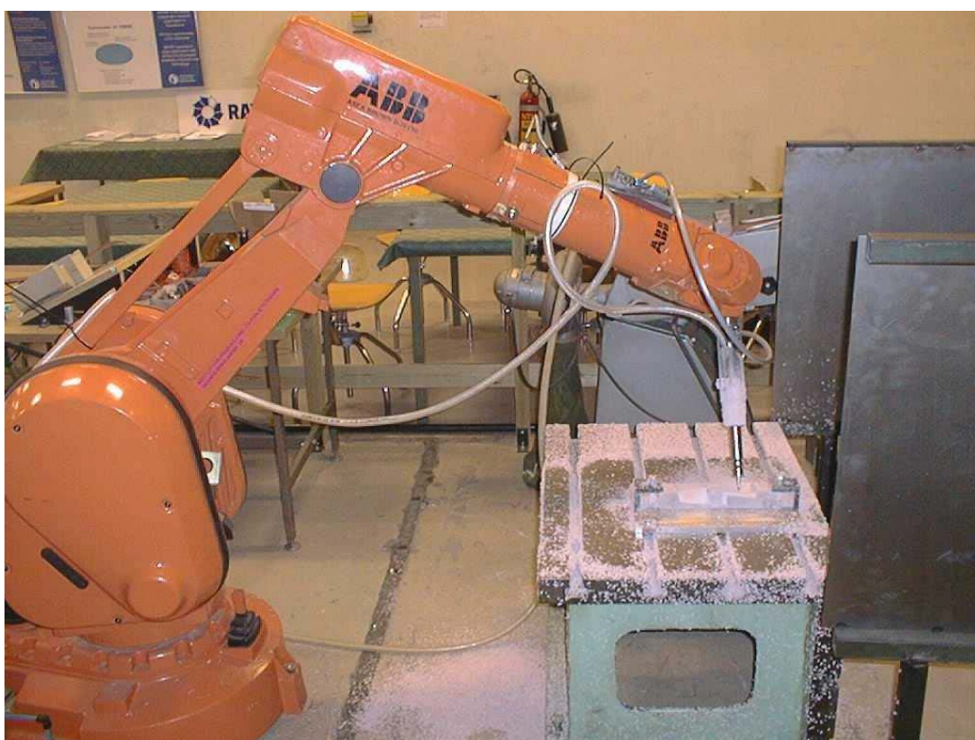
Slika 4.8. Robot vrši 5 - osnu obradu u aluminiju [22]
