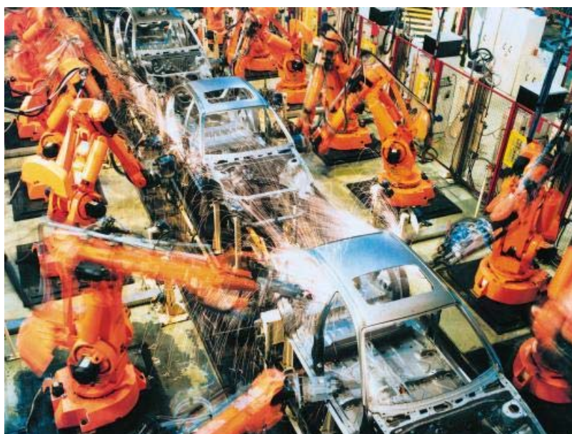
Slika 4.4. Roboti zavaruju karoserije automobila [19]
