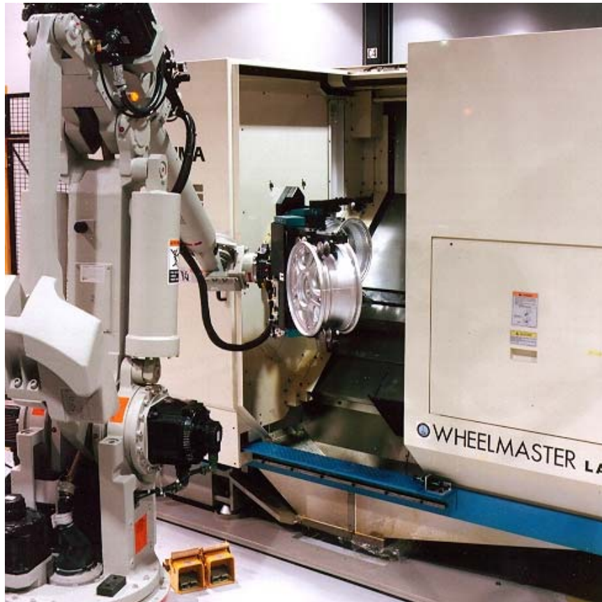
Slika 4.3. Robot skida obradak sa CNC stroja [18]
