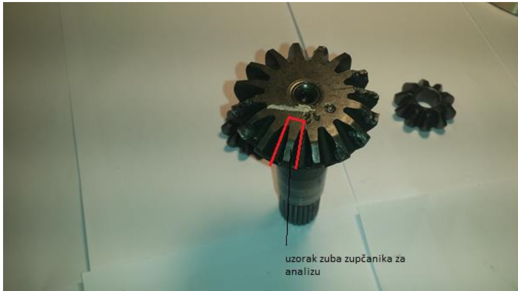
Slika 35. Mjesto uzimanja uzorka za analizu (veliki zupčanik)
