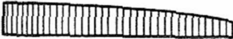
Slika 14a. Neparalelnost površine [7]
