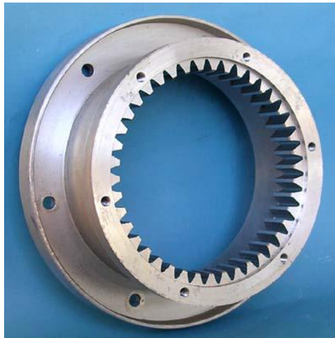
Slika 10. Unutarnji zubi zupčanika dobiveni iglom za provlačenje [4]
