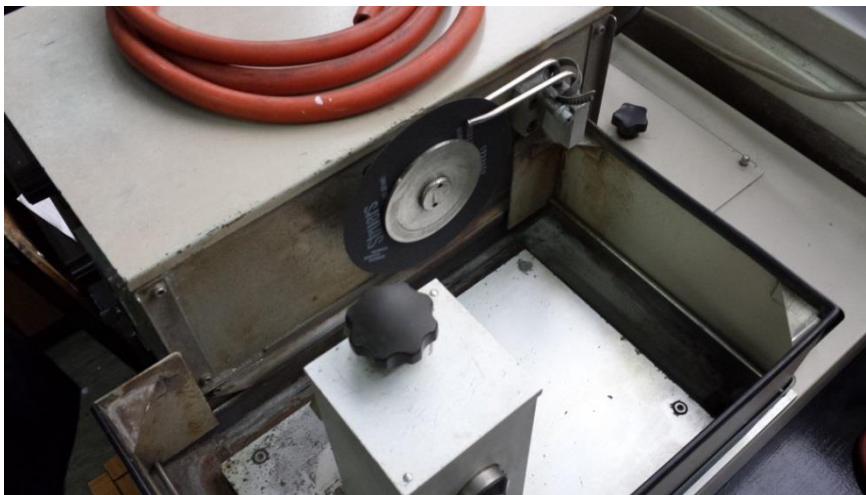
Slika 36. Stroj za rezanje uzorka za analizu.
