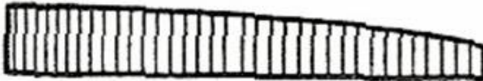
Slika 14a. Neparalelnost površine [7]
