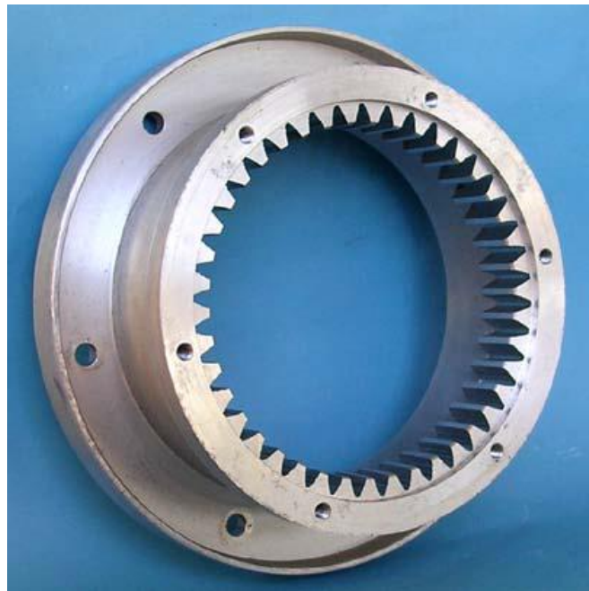
Slika 10. Unutarnji zubi zupčanika dobiveni iglom za provlačenje [4]
