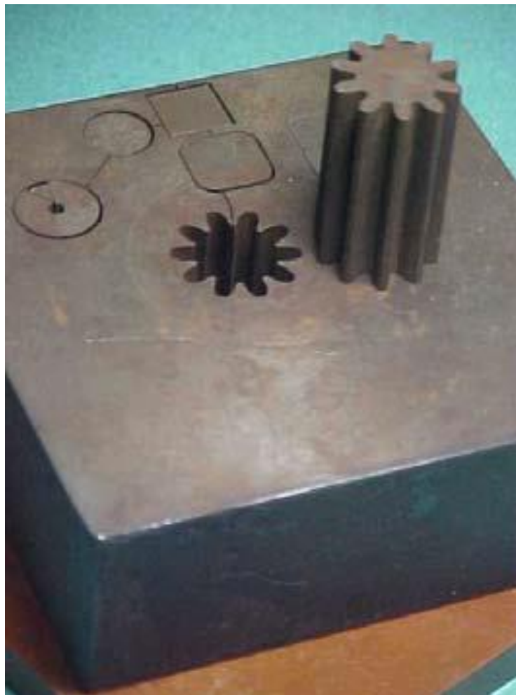
Slika 7. Proizvodnja vanjskih ili unutarnjih čeonih zupčanika metodom Wire EDM [3]
