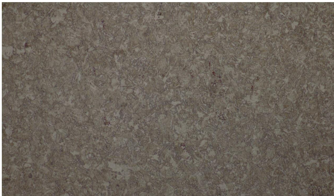
Slika 40a. Mikrostruktura velikog zupčanika – sredina, povećanje 500x
