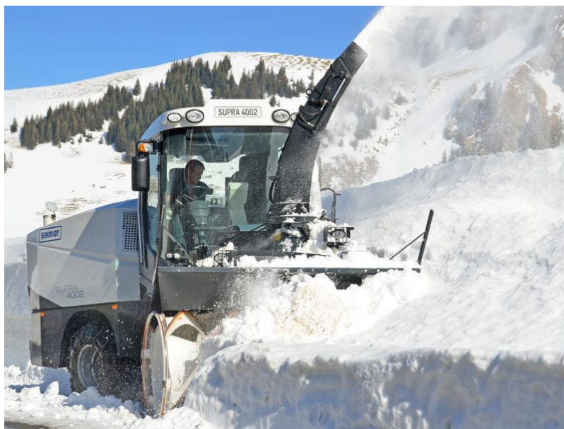
Slika 11. Puhalice kao sastavni dio većeg stroja
