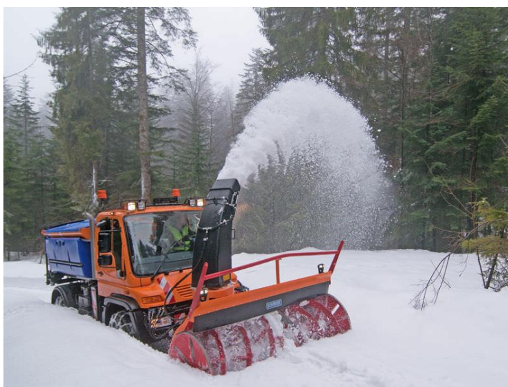
Slika 10. Puhalica pričvršćena za vozilo od kojeg dobiva i moment
