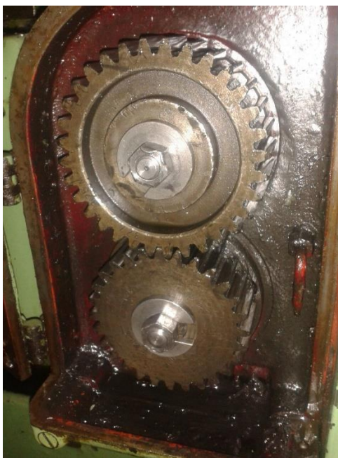
Slika 3.3 Zupčanički prijenosnici za namještanje brzine rezanja
