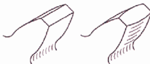
Slika 4.29 Ravno i bombirano ozubljenje u 3D
