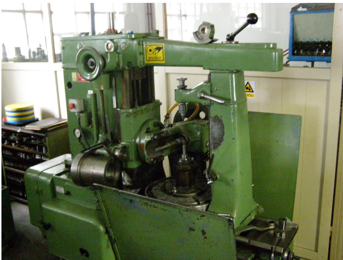
Slika 1.3 Stroj za odvalno glodanje koji će biti nadograđen upravljačkim sustavom
