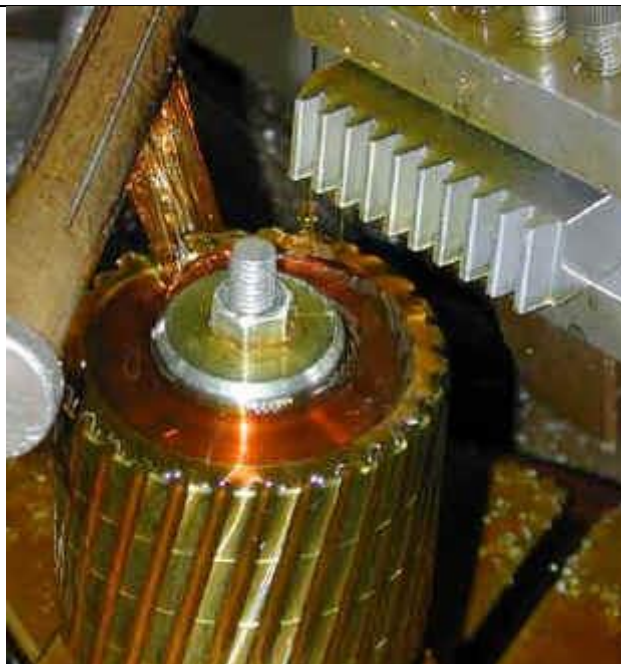
Slika 2.4 Izrada ozubljenja na stroju "MAAG"
