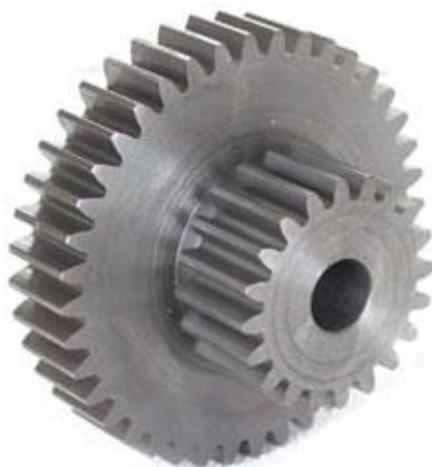
Slika 2.10 Primjer zupčanika gdje je ozubljenje s manjim brojem zubi nužno napraviti postupkom odvalnog blanjanja ili odvalnog dubljenja
