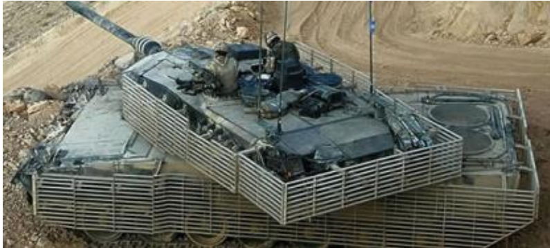
Slika 2. Standoff oklop na Leopardu 2 [2]
