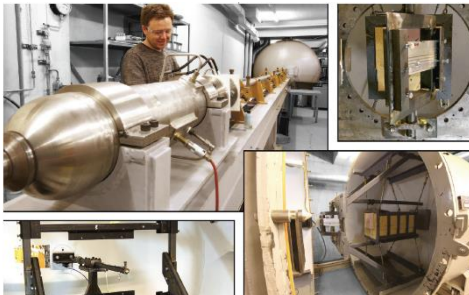
Slika 8. Eksperimentalni postav za ispitivanje probijanja [18]
