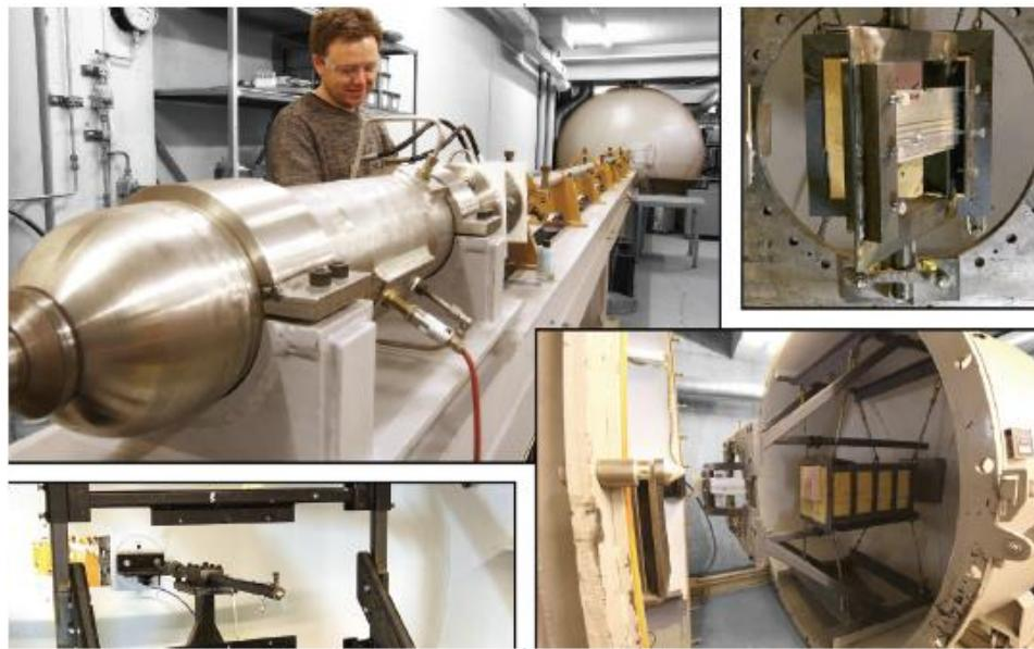
Slika 8. Eksperimentalni postav za ispitivanje probijanja [18]
