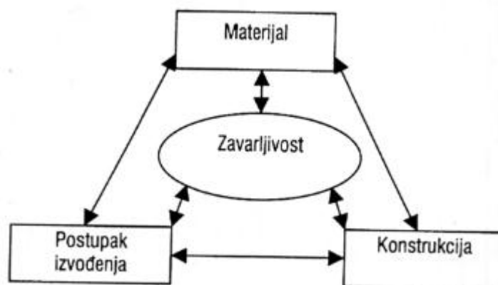
Slika 20. Glavni faktori koji utječu na zavarljivost
