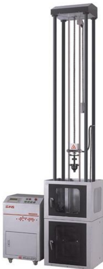
Slika 24. Pellini ispitni uređaj [10]
