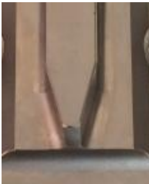
Slika 37. Geometrija noža bata
