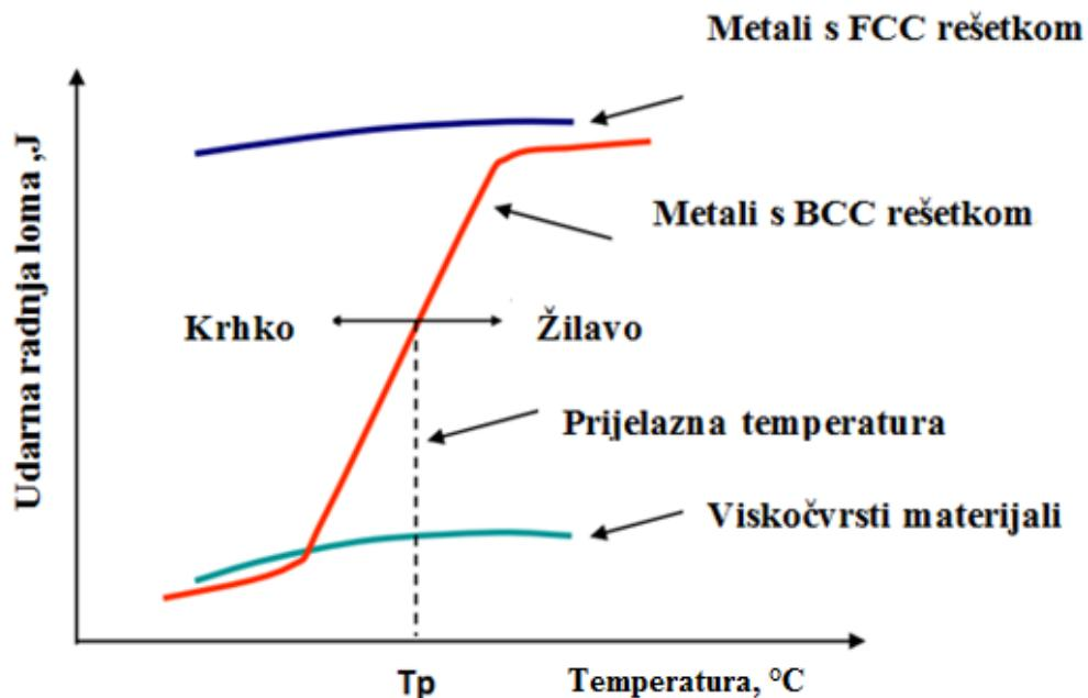
Slika 3. Utjecaj temperature ispitivanja na udarnu radnju loma [5]
