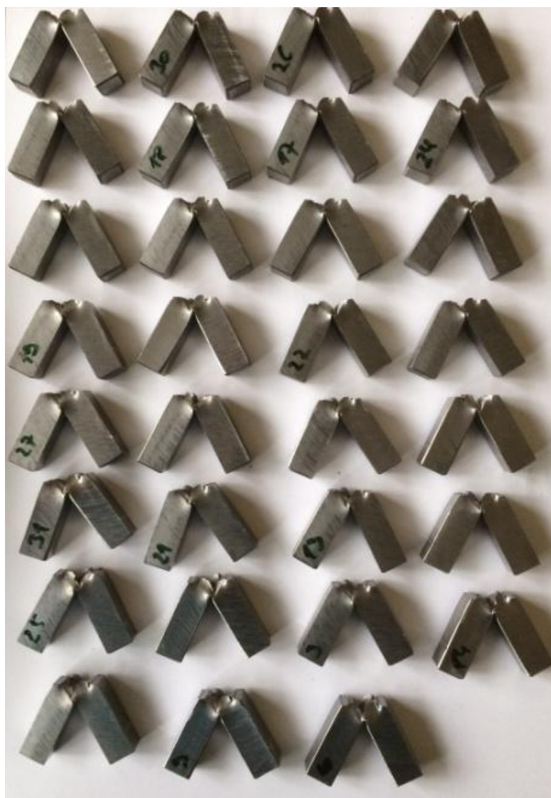
Slika 43. Prikaz slomljenih uzoraka
