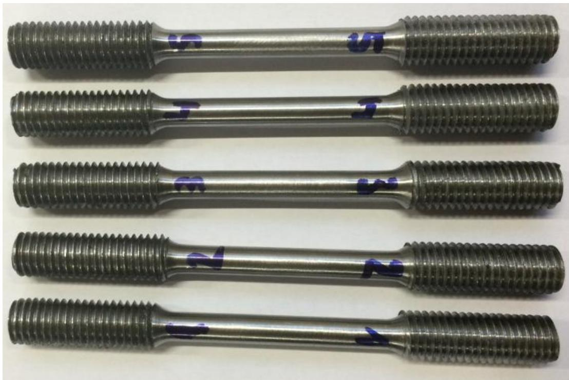
**Slika 49. Epruvete za statičko vlačno ispitivanje**
