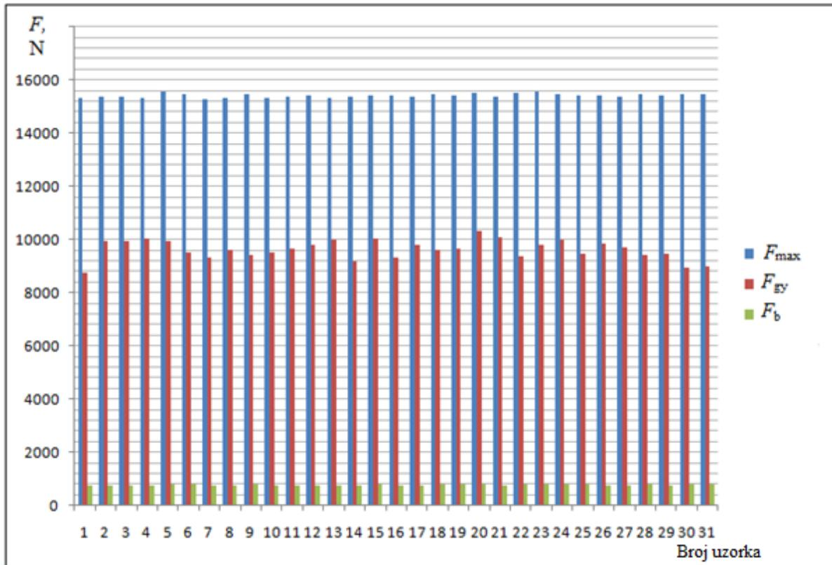
Slika 62. Vrijednosti sila dobivenih instrumentiranom metodom
