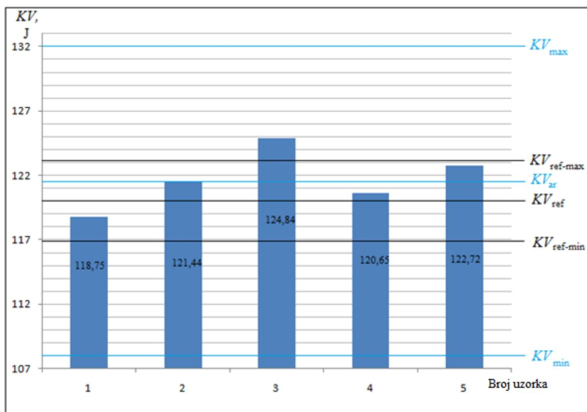
**Slika 57. Dijagram udarnog rada loma referentnih uzoraka (120 J)**
