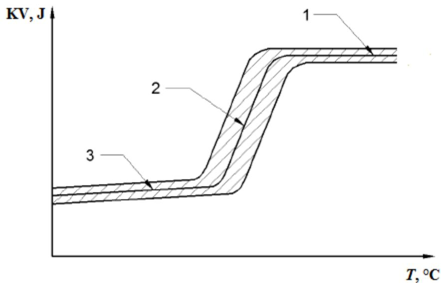
**Slika 19. Shematski prikaz krivulje apsorbirane energije i temperature [9]**
