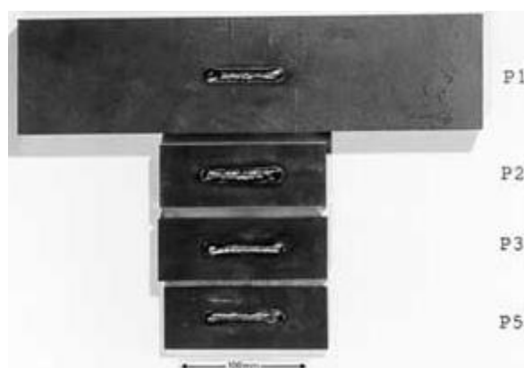
Slika 25. Ispitni uzorci Pellini metode [11]
