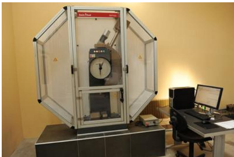
Slika 26. Instrumentirani Charpy-ev bat [16]
