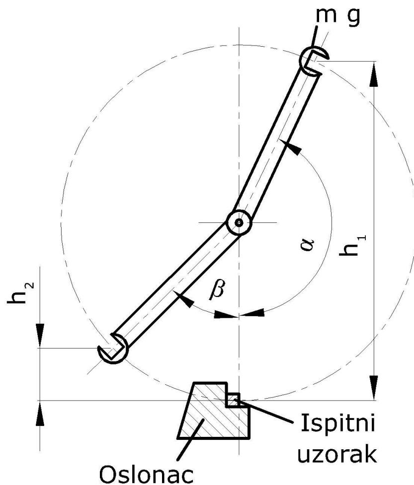
Slika 7. Ispitivanje udarnog rada loma na Charpy-evom batu [13]
