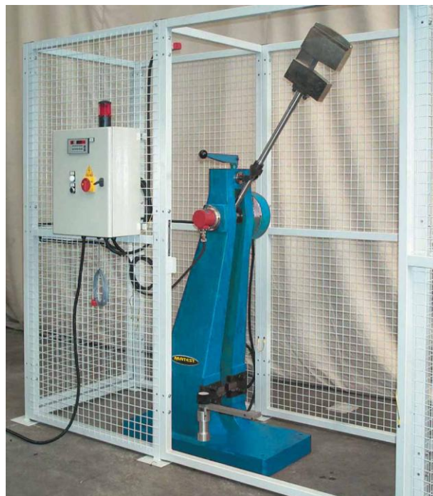
Slika 10. Uređaj za ispitivanje Charpy metodom, Atico
