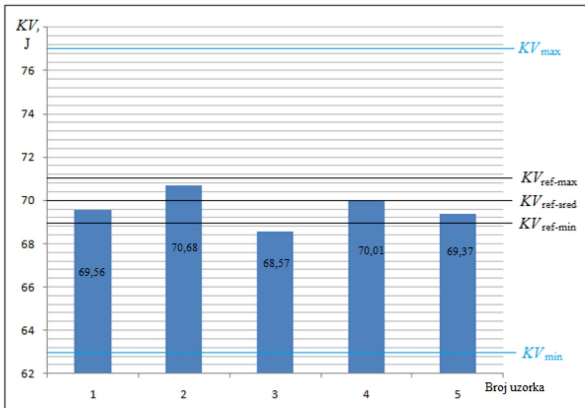
**Slika 56. Dijagram udarnog rada loma referentnih uzoraka (70 J)**
