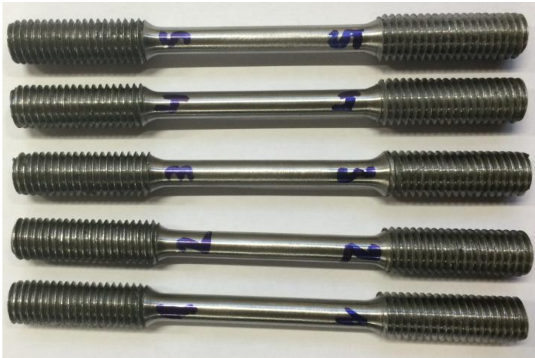
Slika 49. Epruvete za statičko vlačno ispitivanje
