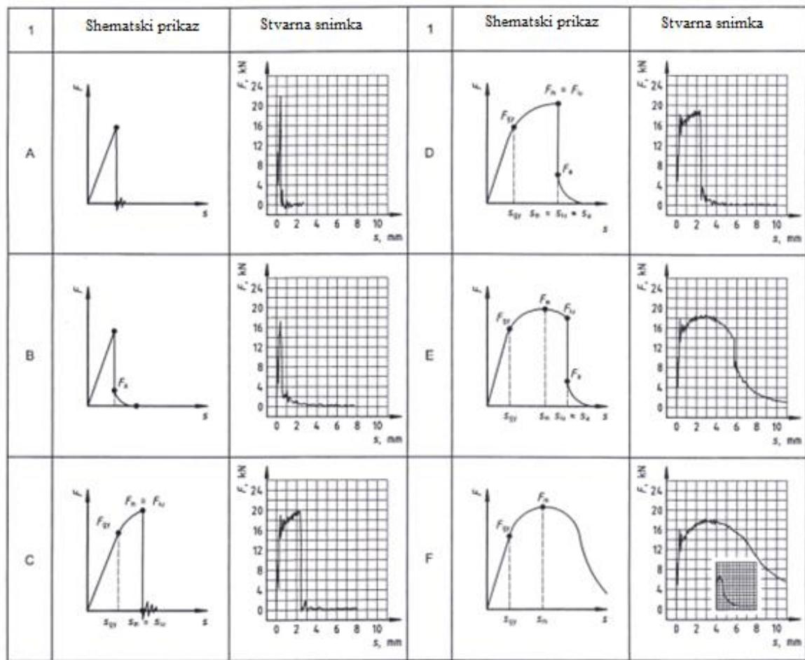
Slika 32. Prikaz karakterističnih krivulja dobivenih instrumentiranim Charpy-evom metodom [18]
