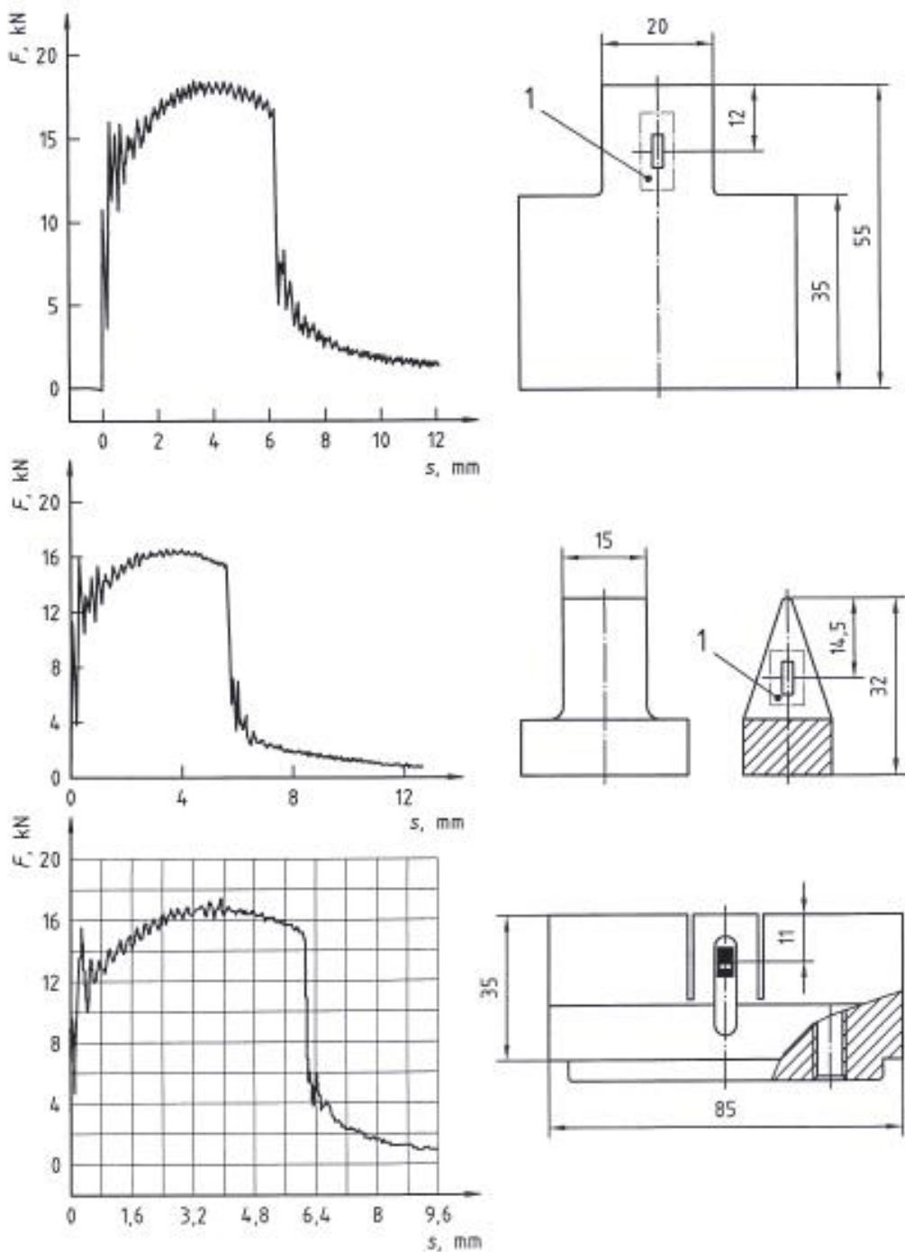
Slika 30. Konstrukcija instrumentiranog noža te pridružene krivulje [18]
