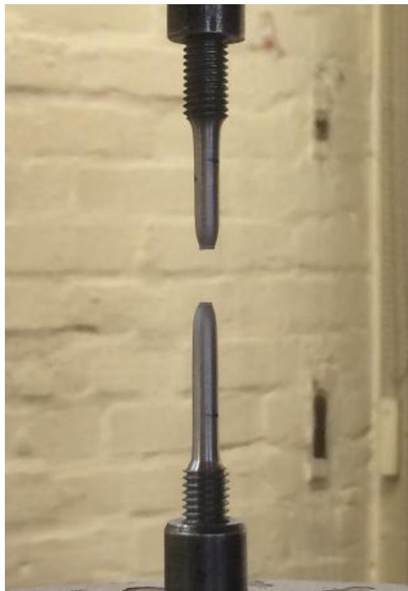
**Slika 54. Lom epruvete**
