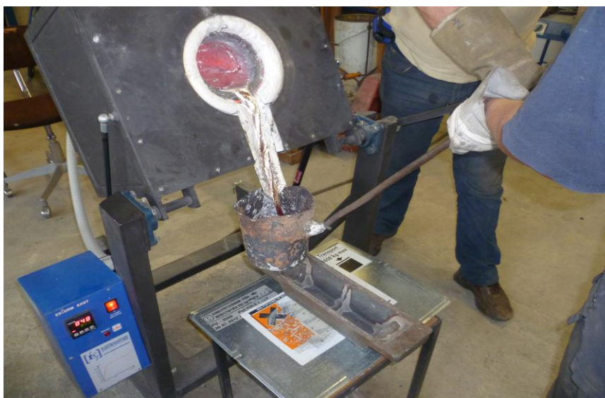
Slika 64. Ulijevanje taljevine iz peći u ljevački lonac
