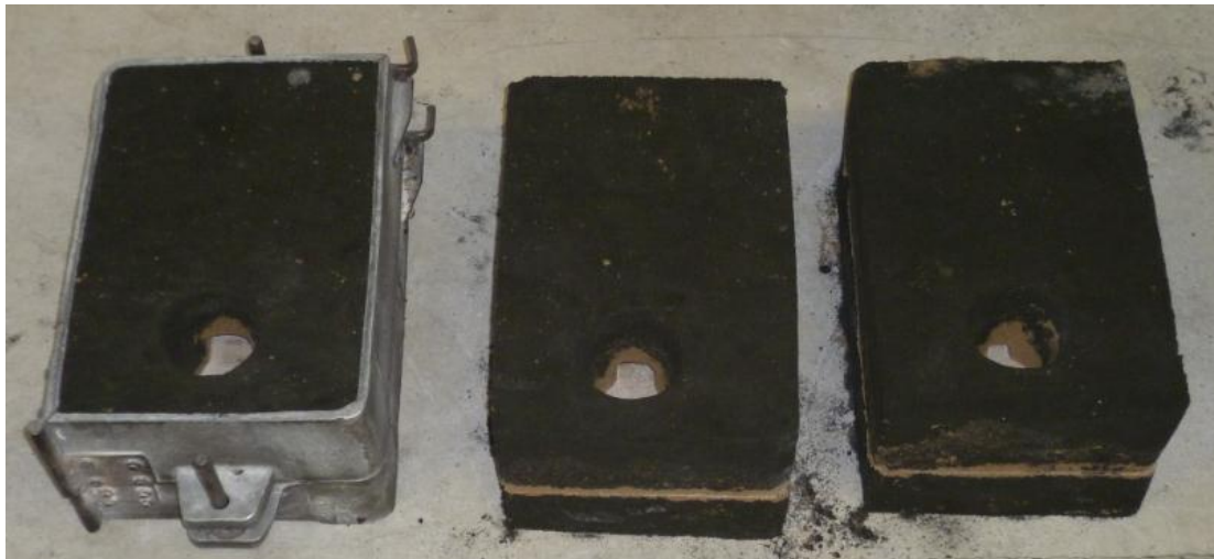
Slika 60. Gotovi kalupi sa različitim vratovima pojila
