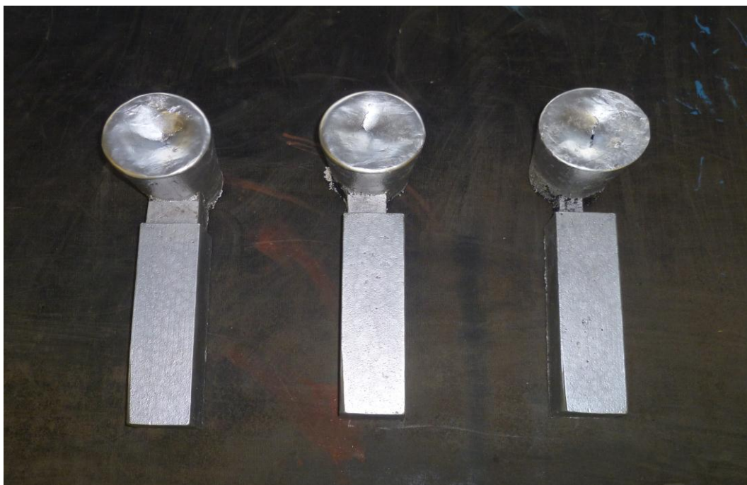
Slika 69. Gotovi odljevci sa uljevnim sustavom
