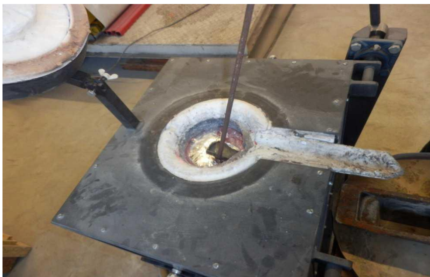
Slika 63. Uklanjanje nečistoća (oksida)
