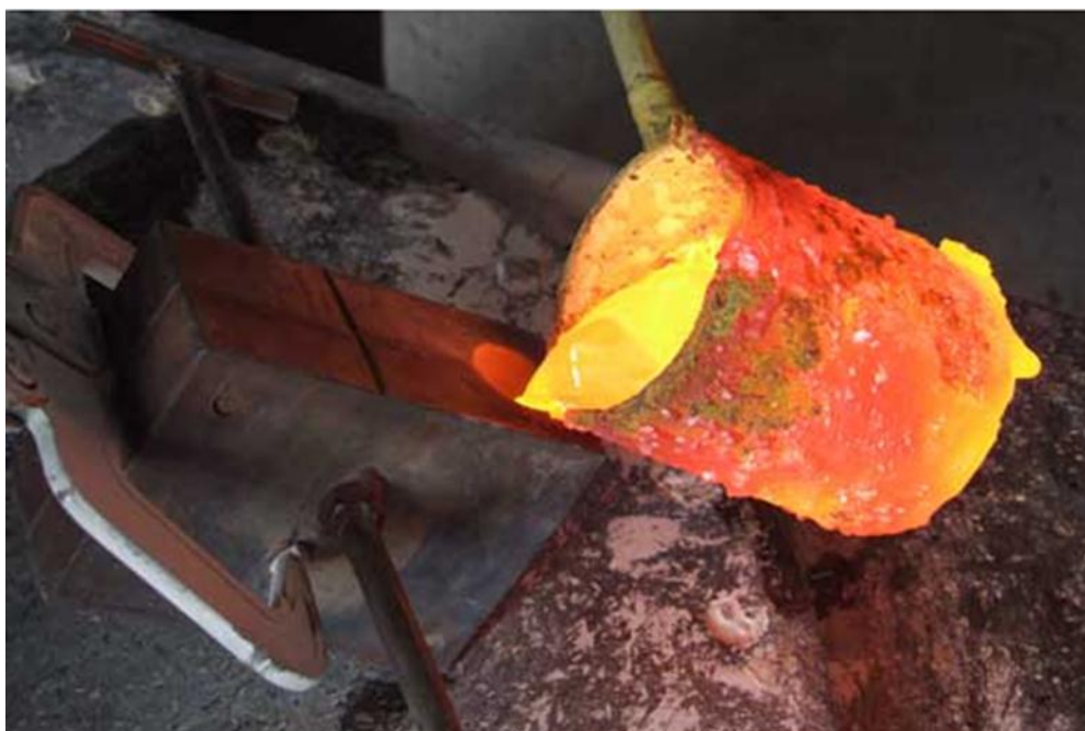
Slika 1. Lijevanje metala u kalup [5]
