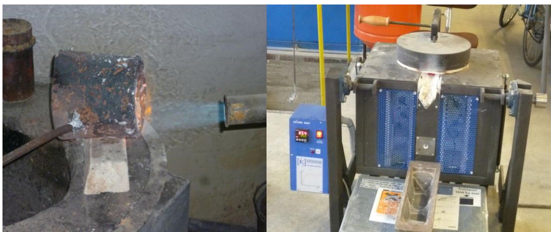
Slika 61. Zagrijavanje ljevačkog lonca i elektrootporne peći s taljevinom aluminija
