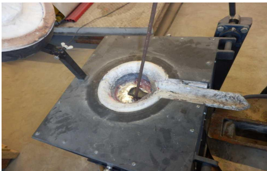
Slika 63. Uklanjanje nečistoća (oksida)
