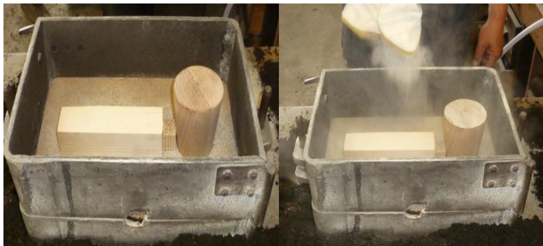
Slika 54. Pozicioniranje modela sa uljevnim sustavom i nanošenje likapodija
