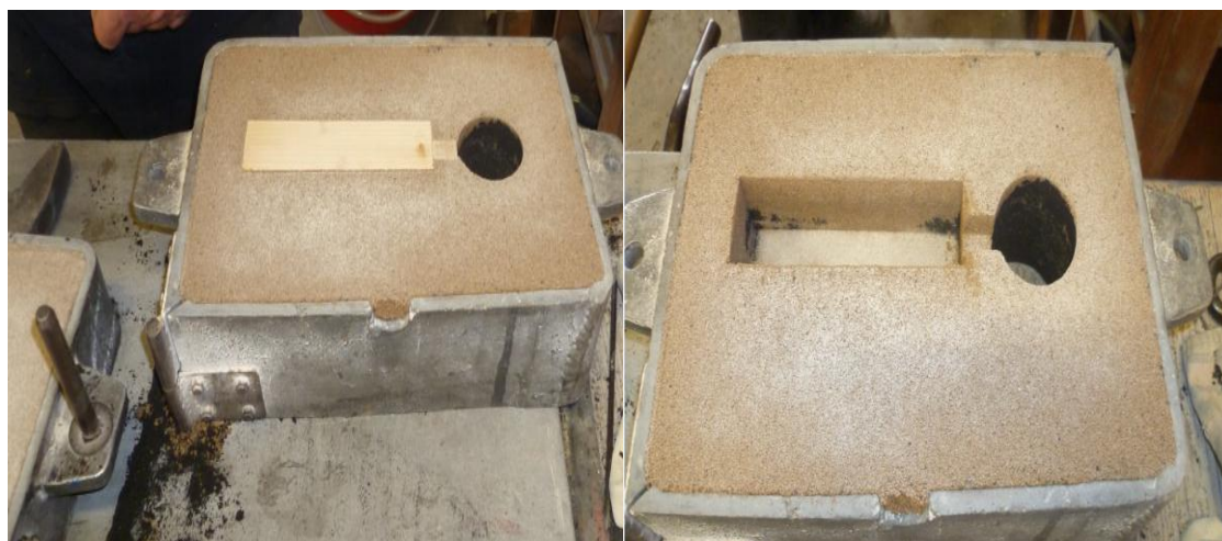
Slika 58. Uklanjanje modela i vrata pojila
