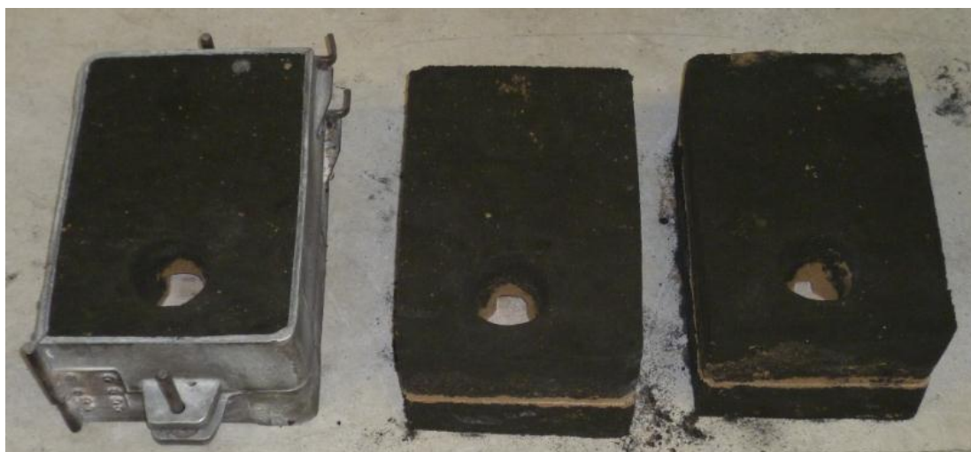
Slika 60. Gotovi kalupi sa različitim vratovima pojila
