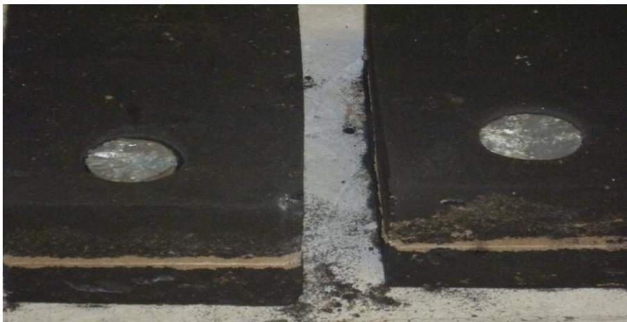
Slika 67. Kalup i pojilo nakon skrućivanja odljevka
