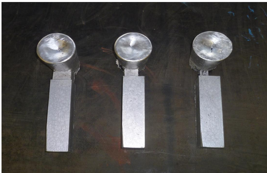
Slika 69. Gotovi odljevci sa uljevnim sustavom
