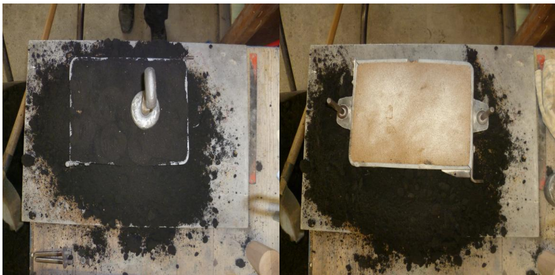
Slika 53. Sabijanje kalupne mješavine i rotacija donjaka kalupa za 180°
