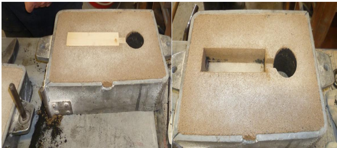
Slika 58. Uklanjanje modela i vrata pojila
