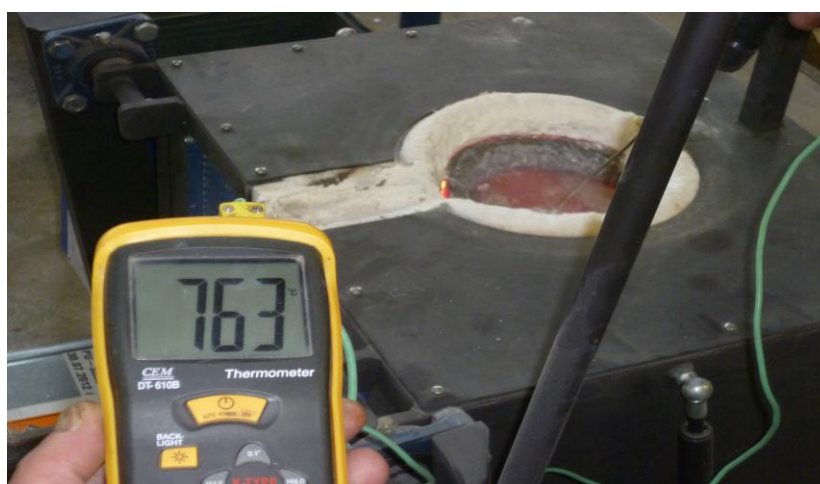
Slika 62. Mjerenje temperature taljevine pirometrom
