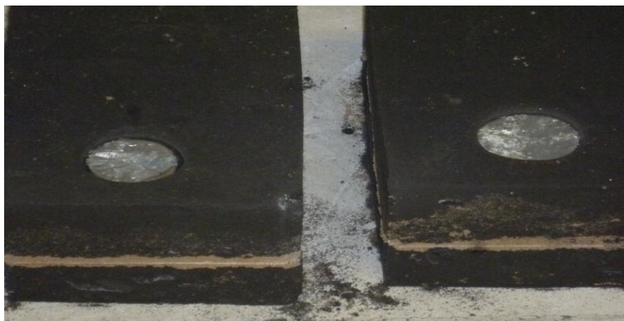
Slika 67. Kalup i pojilo nakon skrućivanja odljevka
