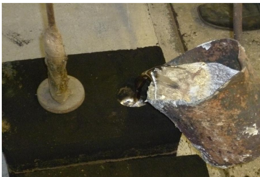
Slika 66. Ulijevanje taljevine u kalup
