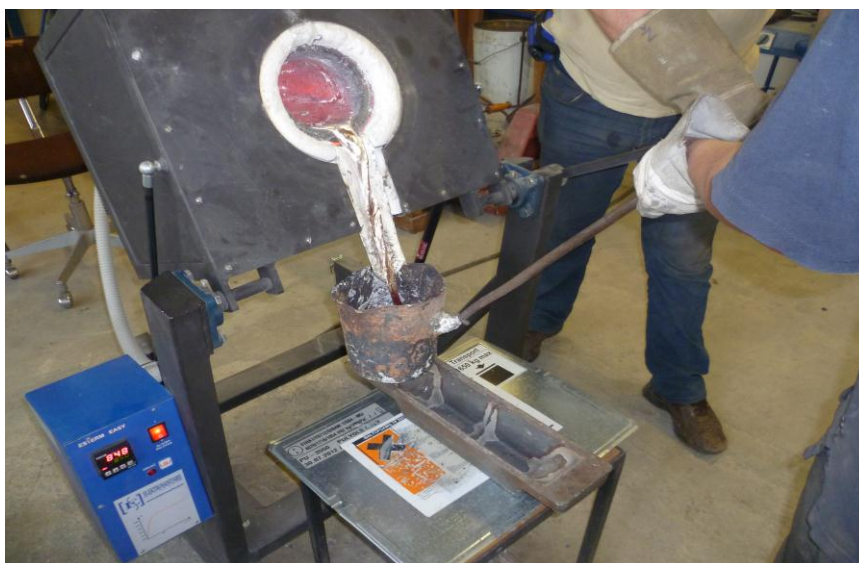
Slika 64. Ulijevanje taljevine iz peći u ljevački lonac
