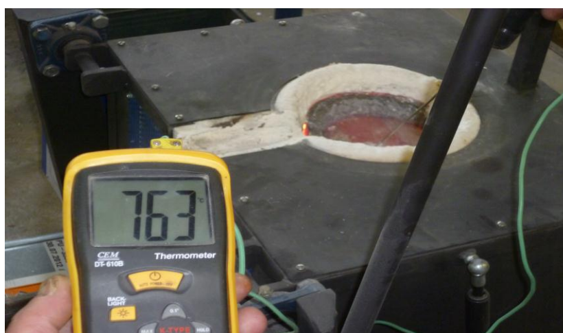
Slika 62. Mjerenje temperature taljevine pirometrom
