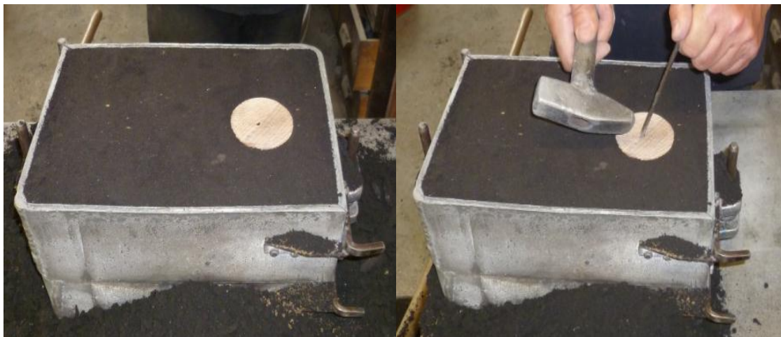
Slika 57. Uklanjanje pojila koje u našem slučaju služi kao spust
