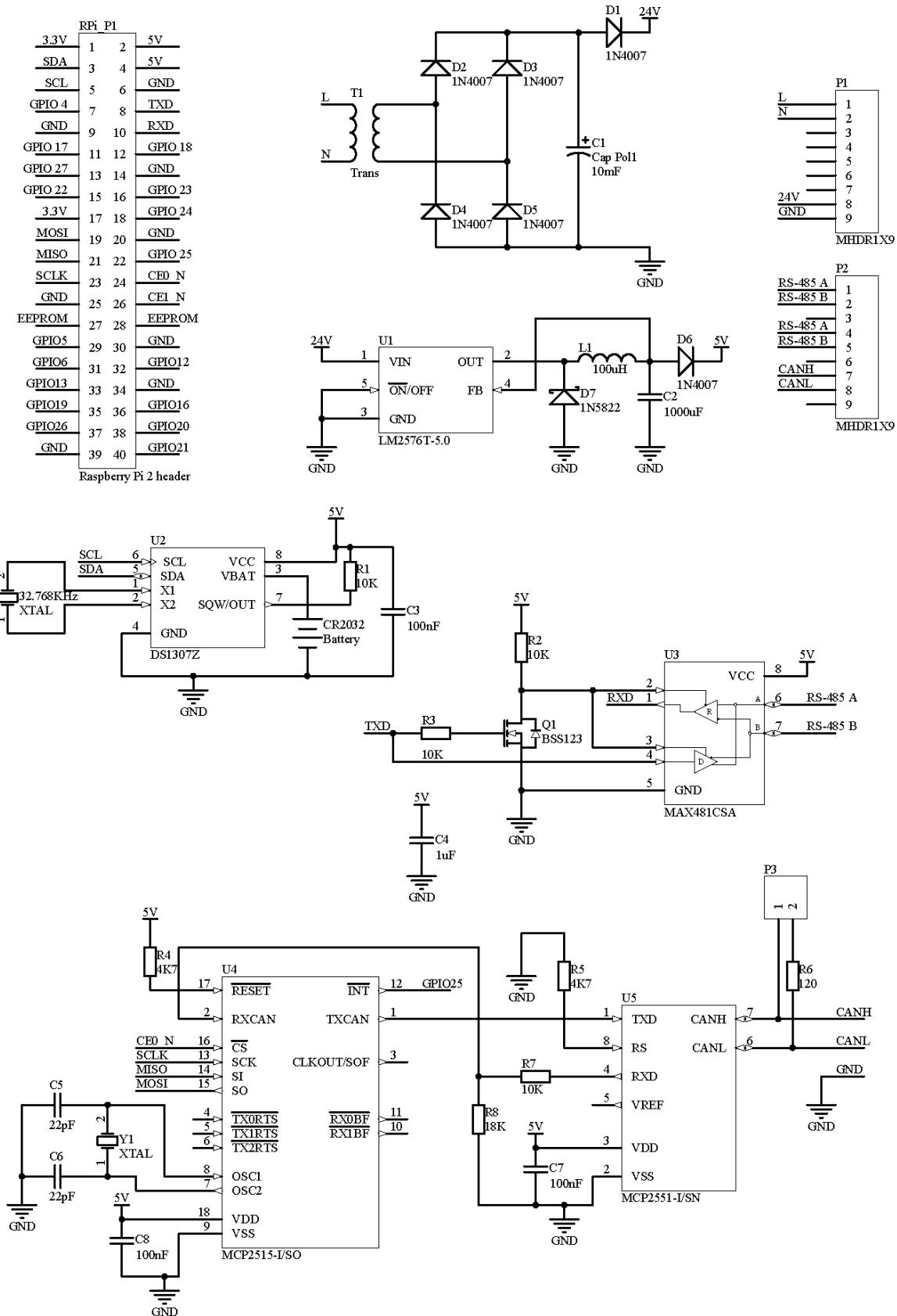
Slika 10. Električna shema dodatne pločice
