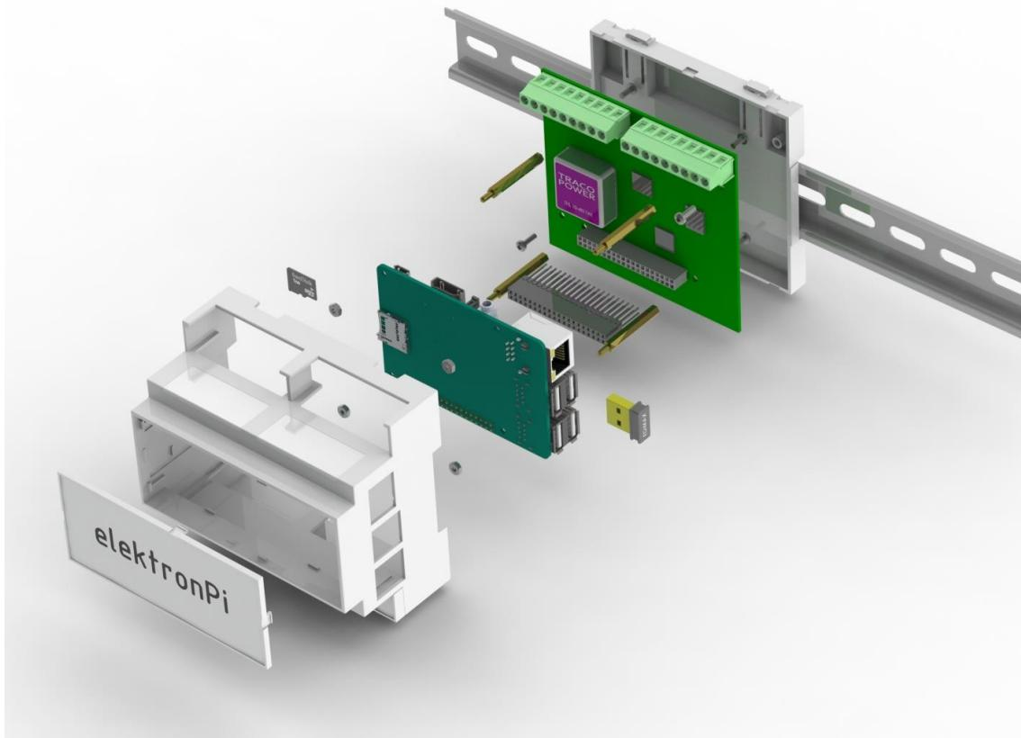
**Slika 9. Uređaj za nadzor i upravljanje – dijelovi**
