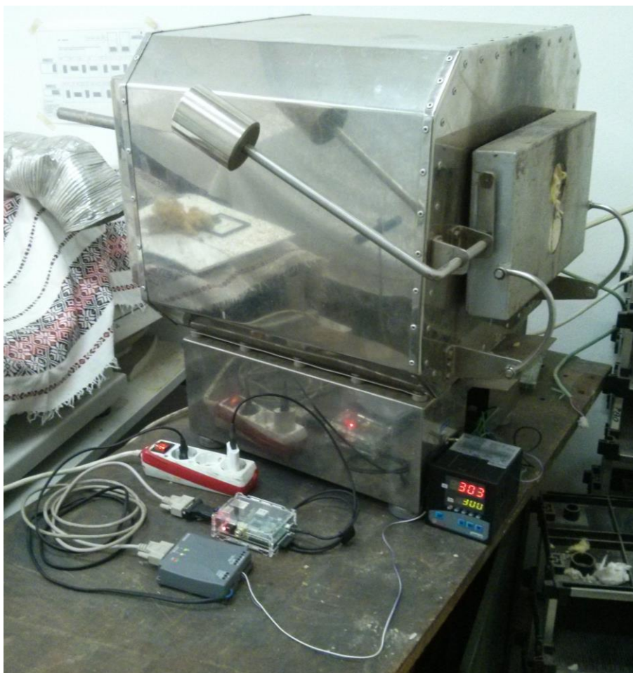
Slika 35. Ispitivanje uređaja na regulatoru GAMA-3k
