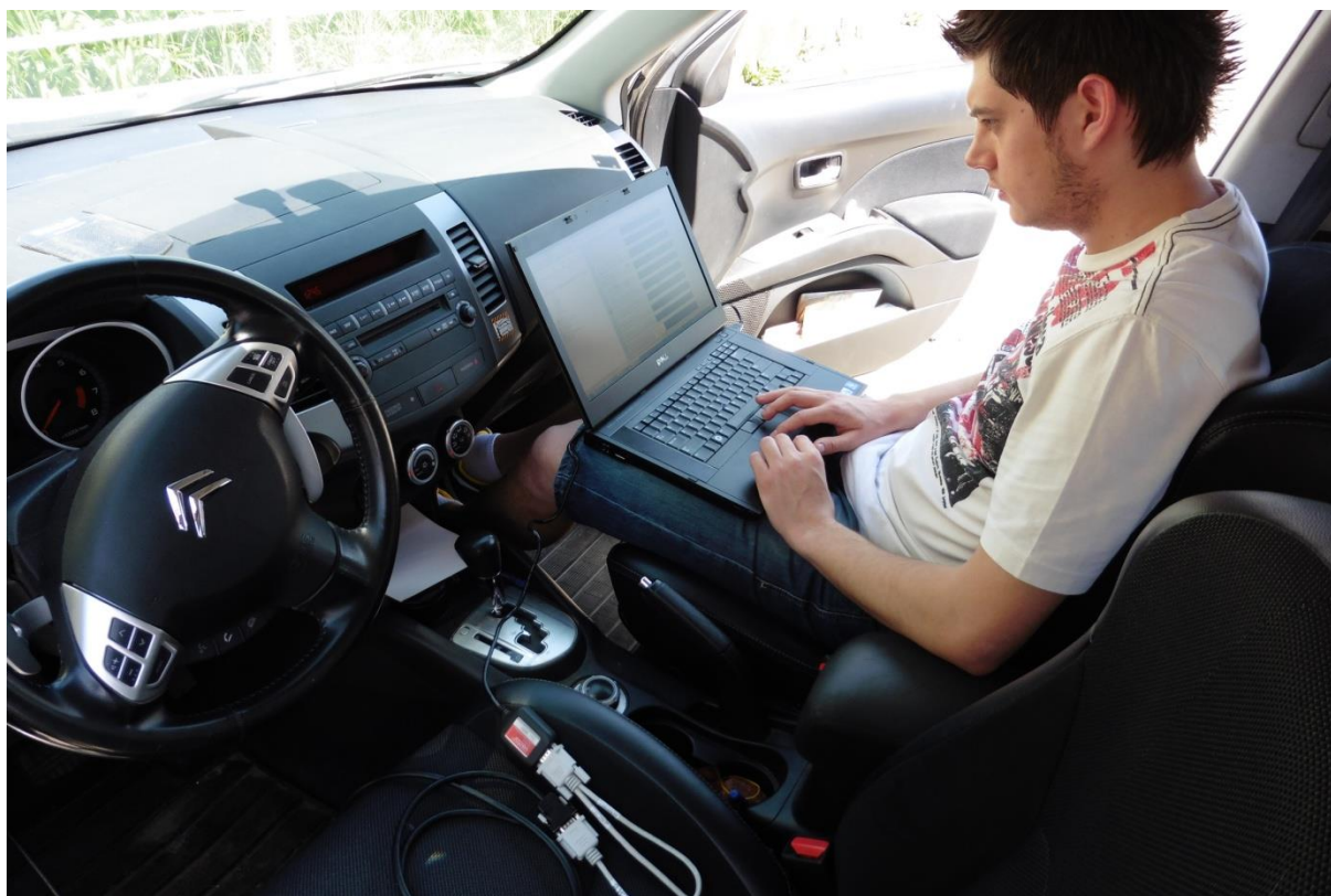
Slika 49. Spajanje prijenosnog računala preko dijagnostičkog uređaja VN1611 na EOBD priključnicu vozila Citroën C-Crosser.
