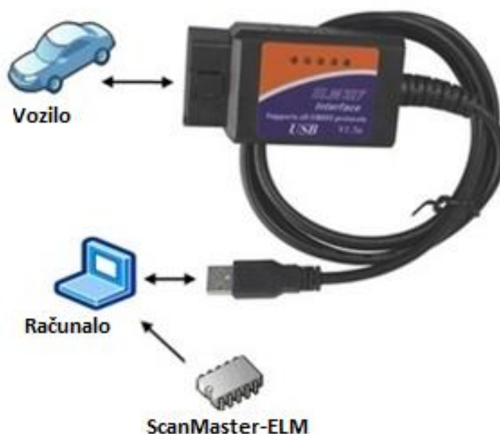
Slika 56. Postupak spajanja prijenosnog računala na CAN sabirnički sustav vozila koristeći dijagnostički uređaj ELM 327.
