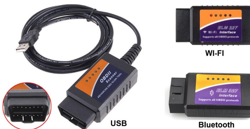
Slika 21. Fotografija ELM 327 sučelja za spajanje na EOBD priključnicu [16.].
