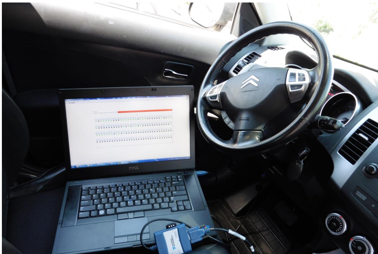
Slika 28. Spajanje prijenosnog računala preko dijagnostičkog uređaja NI USB-8473s na EOBD priključnicu vozila Citroën C-Crosser.
