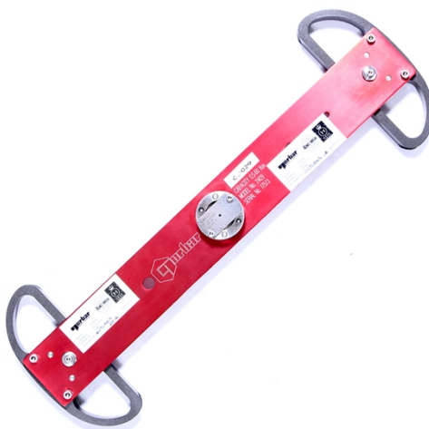
Slika 6. Poluga za umjeravanje marke Norbar [3]
