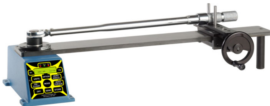
Slika 10. STWCS mjerna jedinica s priključkom za opterećivanje [6]
