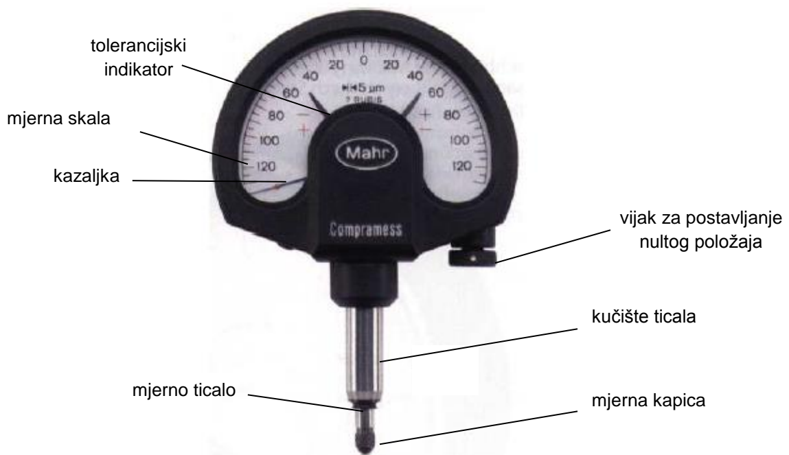
Slika 44. Sastavni dijelovi komparatora [7]
