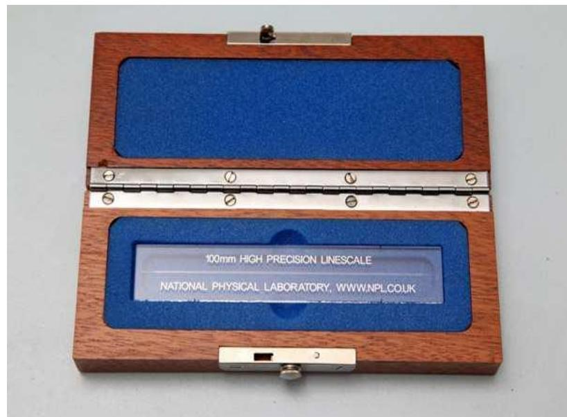
**Slika 11.** Precizna staklena mjerna skala NPL, SM/RET 228-513 [15]
