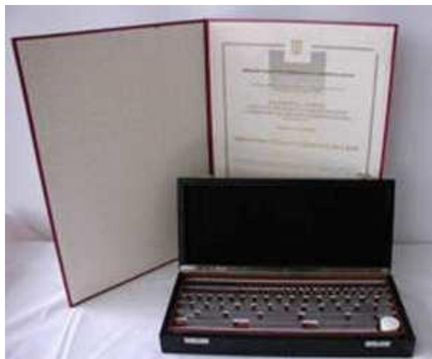
**Slika 9.** Planparalelne granične mjerke [15]
