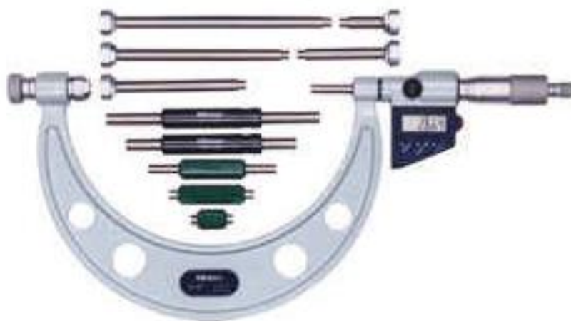
Slika 31. Mikrometar za vanjska mjerenja s promjenjivim nakovnjem [11]
