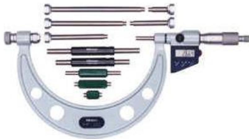
Slika 31. Mikrometar za vanjska mjerena s promjenjivim nakovnjem [11]
