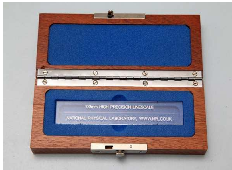
Slika 11. Precizna staklena mjerna skala NPL, SM/RET 228-513 [15]
