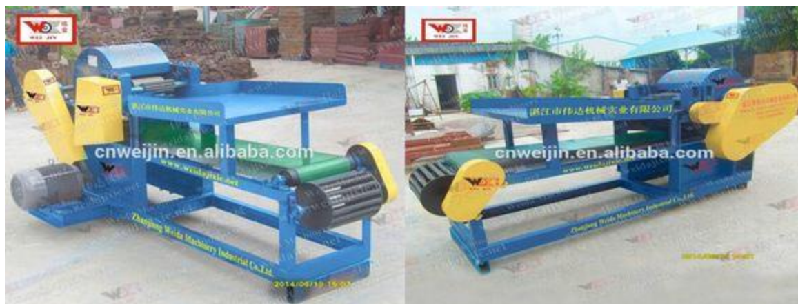
Slika 3. Stroj za izdvajanje vlakana „WEIJIN ZGM-4401“
