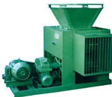
Slika 5. Stroj za prelamanje stabljika tvrtke „Godwell India“
